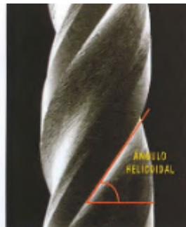
Fig. 3.- Trazado del ángulo helicoidal en un instrumento.
