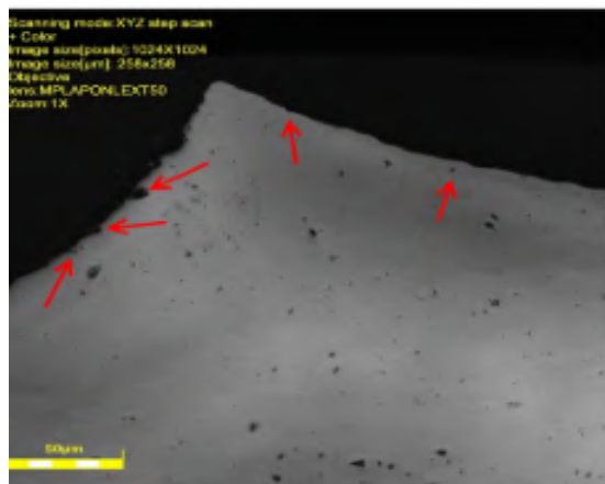
Fig. 33.- Poros en el volumen y en los bordes de la espira de una lima TF (Flechas).
