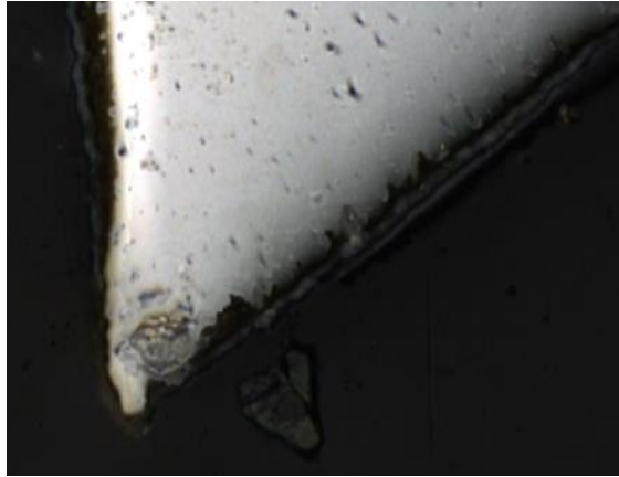
Fig. 31.- Corte transversal de una lima TF. Presencia de irregularidades en sus bordes
