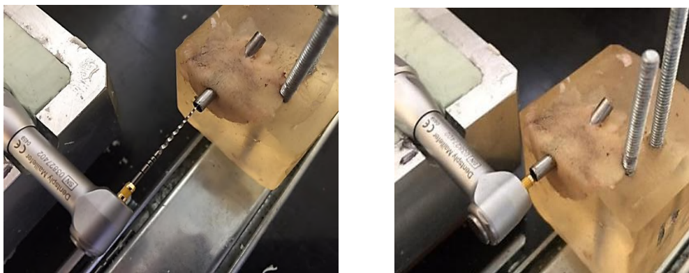
Fig. 10.- Dispositivo de acrílico en el cual se montaron los tubos.
