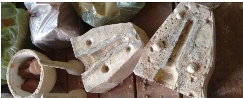
MOLDE PARA FABRICAR CONOS DE ARCILLA, ELEMENTO DEL TALLER MÓVIL 2016 (IMAGEN 02)
