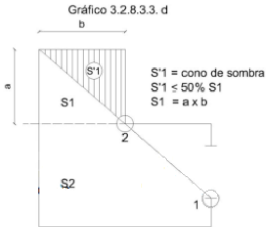
Figura 2.03 Iluminación en caso de quiebres en L.
