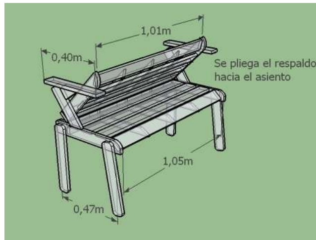
Proyección isométrica (técnica) del banco plegable.
