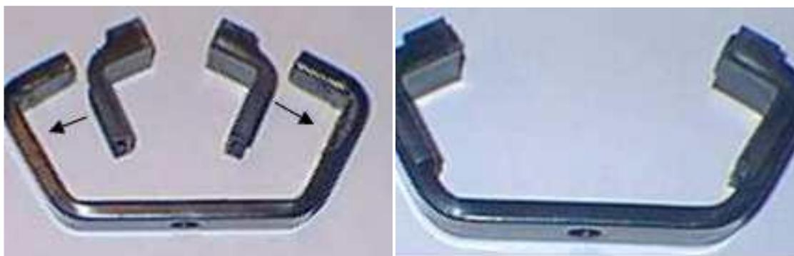
Figura 5.2. Colocación de inserto en abrazadera.
