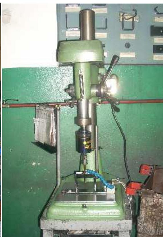
Figura 1.6. Taladradora con cabezal roscador.
