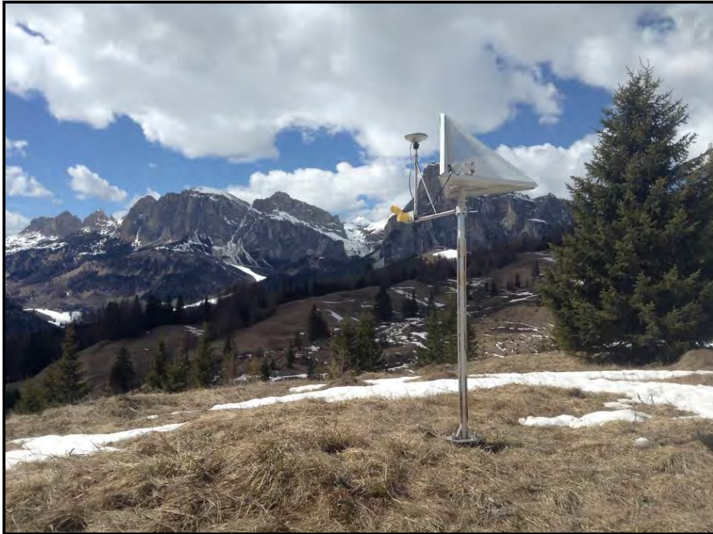
Figura 8: Uno de los Corner Reflectors instalados sobre el cuerpo del deslizamiento de Corvara. En este caso corresponde a una estación de medición manual. Este Corner Reflector está diseñado para banda X y permite la medición con GPS en la misma locación (Relevamiento propio).
