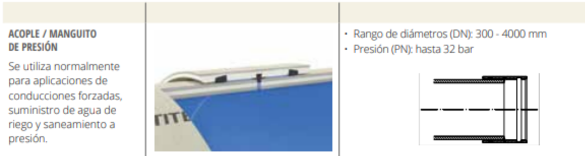
FIGURA N°24: TIPO DE UNION DE CAÑERÍA PRFV DN800mm.
