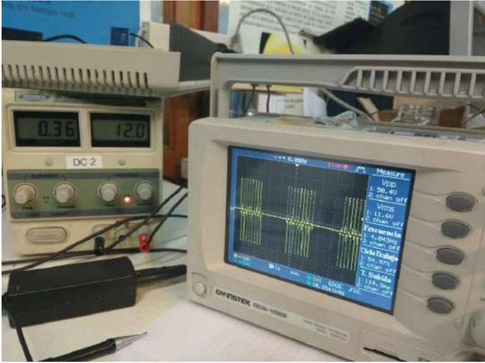
Fig. 4.3 Tren de pulso a 10KHz, Carga 510 ohm
