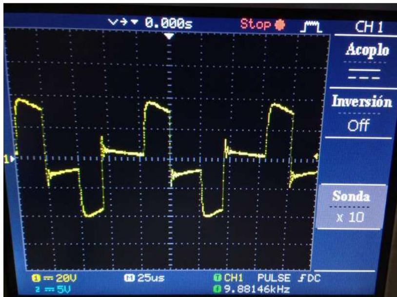
Fig. 4.9 10kHz, Max tensión, ancho de pulso Max.
