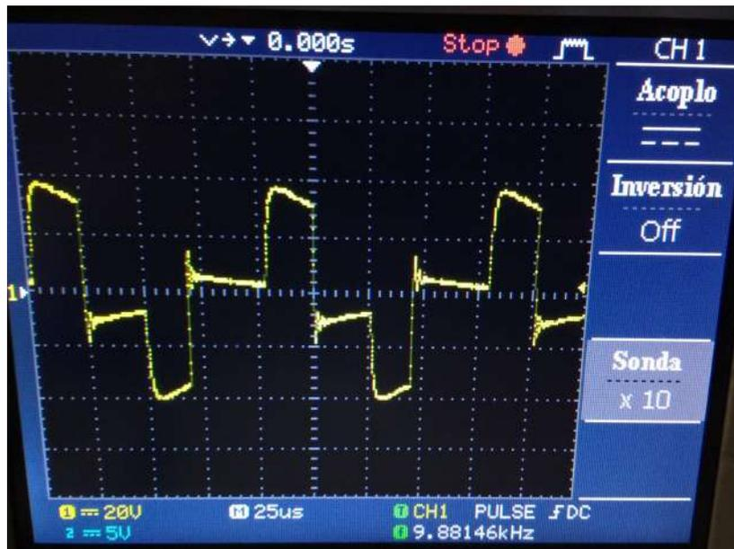
Fig. 4.14 10kHz, Max tensión, ancho de pulso Max.
