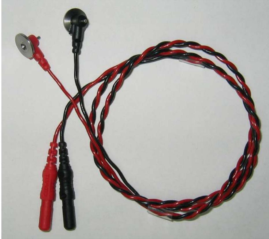
Fig. 2.11 Electrodo de disco (sin arco).
