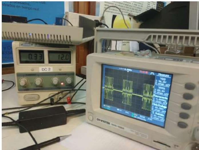
Fig. 4.5 Tren de pulso a 2seg, Carga 1200 ohm
