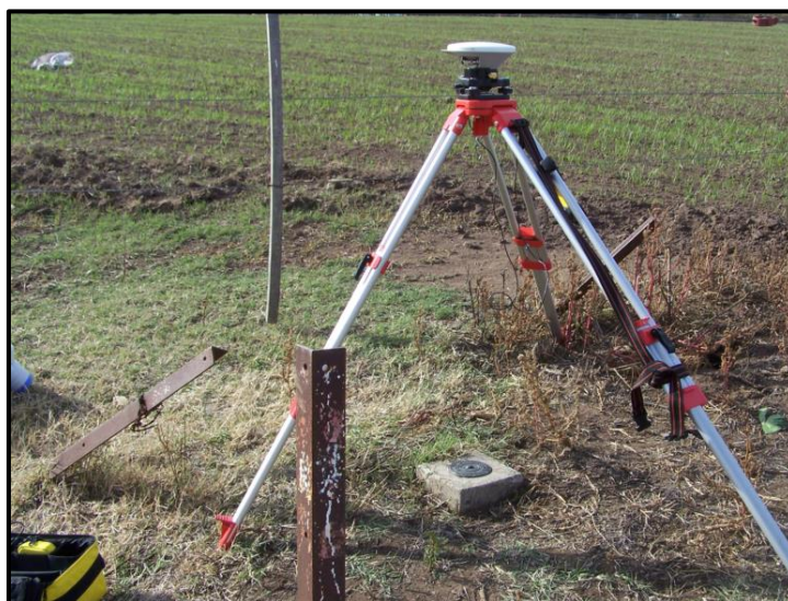
Figura 26. Equipo GNSS estático ubicado sobre el mojón del punto TLAU de la Red Geoba.
