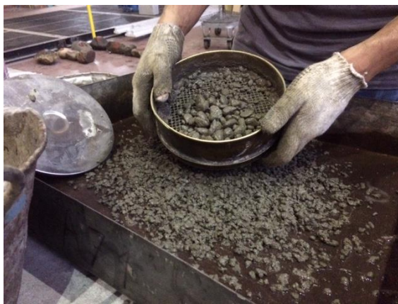
Figura N°26: Tamizado del Hormigón con Tamiz IRAM 4,75 mm.
