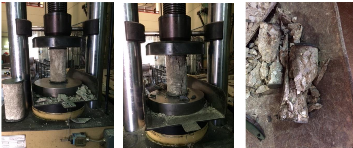
Figura N°23: Ensayo Compresión Simple de probetas de hormigón. Rotura de probeta Tipo 1.
