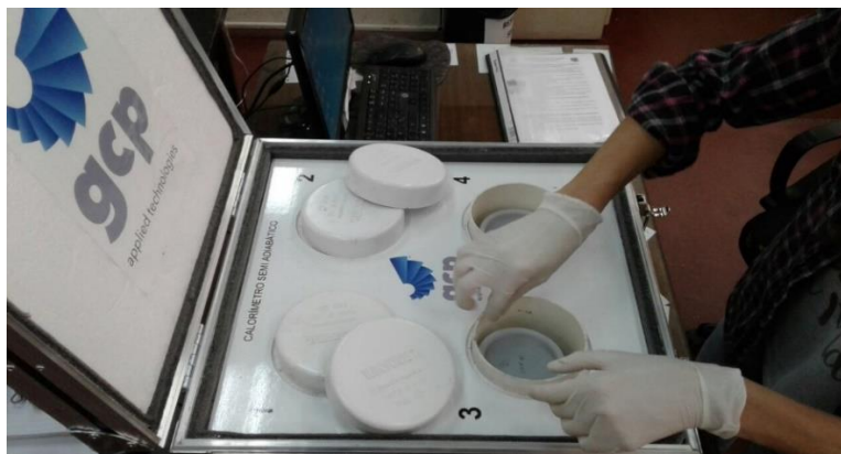
Figura N°30: Colocación de las mini probetas en los puertos 1 y 2 de Calorímetro Semi-Adiabático.
