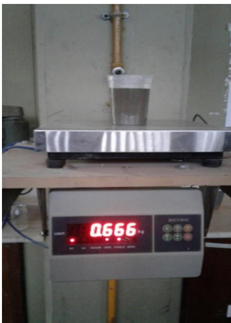
Figura N°29: Peso de mini probetas con balanza con precisión al gramo.
