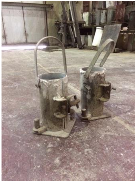
Figura N°20: Probetas cilíndricas para ensayo de Compresión Simple.
