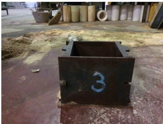
Figura N°21: Probeta prismática para ensayo de Tiempo de Fragüe con Penetrómetro.
