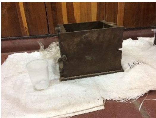
Figura N°24: Probeta prismática para ensayo de Tiempo de Fragüe con Penetrómetro.
