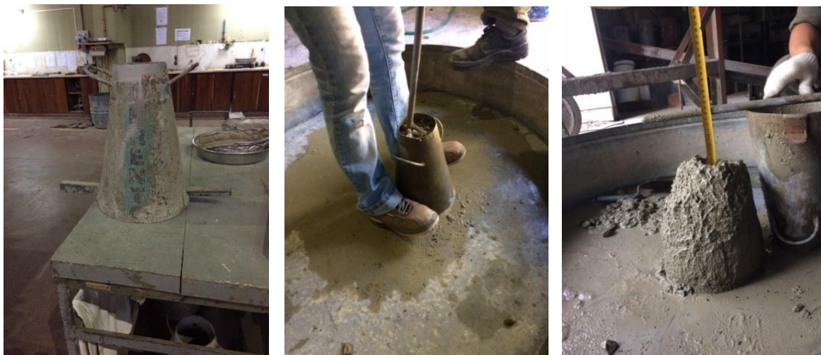
Figura N°19: Realización de Cono de Abrams, para determinar consistencia del hormigón.
