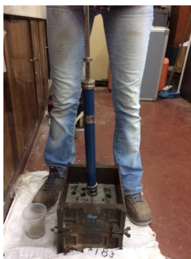
Figura N°28: Penetración con aguja Proctor en la muestra de mortero.
