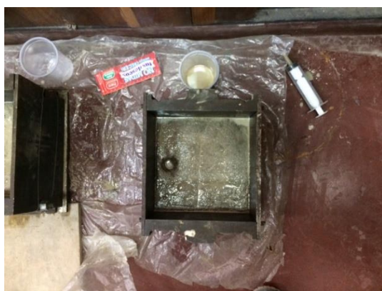
Figura N°27: Retiro del agua de exudación del mortero.
