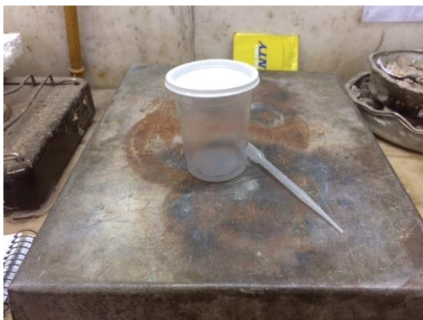
Figura N°22: Mini probeta cilíndrica para ensayo de Tiempo de Fragüe con Calorímetro.
