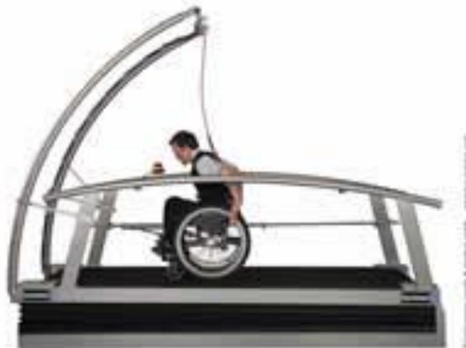
Ilustración 13 – Ergómetro de silla de ruedas con tapiz
