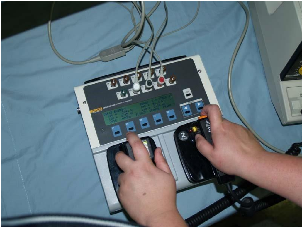
Ilustración 9.4.5 Medición de la salida de energía del desfibrilador
