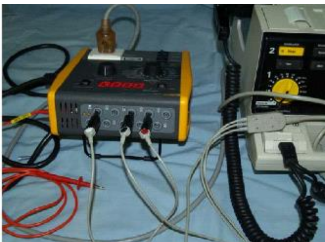
Ilustración 8.5.9 Conexión para la prueba de los terminales de Paciente
