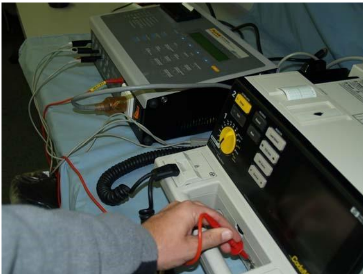
Ilustración 8.5.7 Foto de la prueba de corriente de Fuga del Chasis
