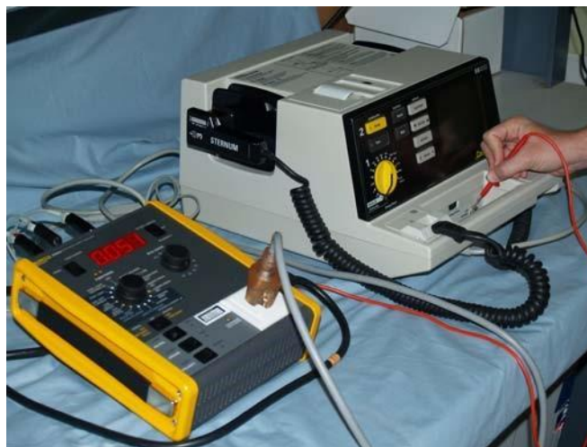
Ilustración 8.5.2 Configuración Típica para realizar la prueba de seguridad eléctrica
