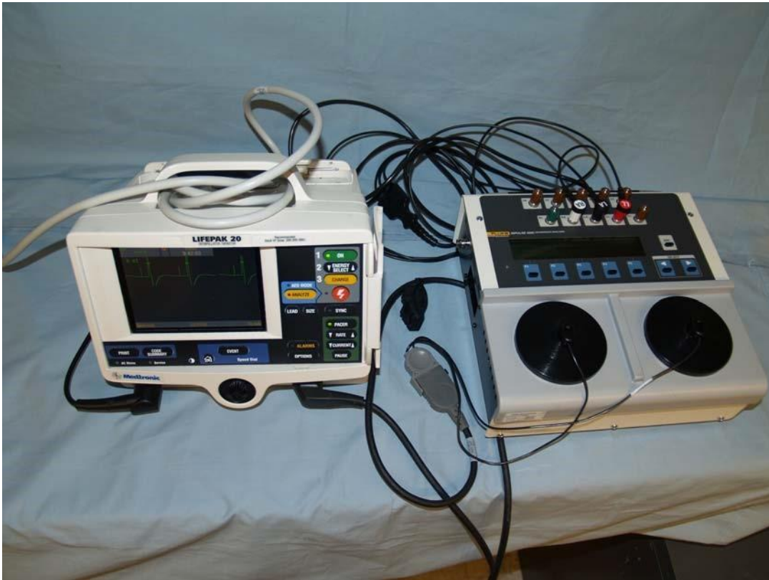
Ilustración 9.4.6 Medición de la salida del marcapasos con Impulse 4000
