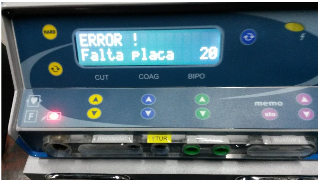
Ilustración 9.5.9 Alarma falta placa
