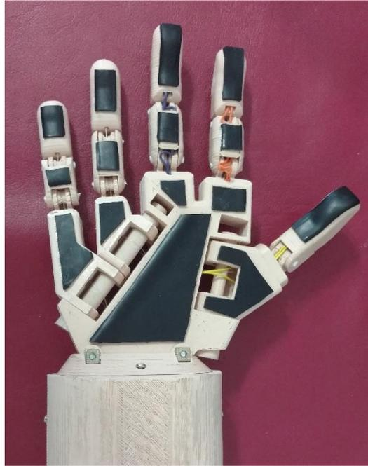
**Ilustración 127 – Mano protésica con pieza de TPU**
