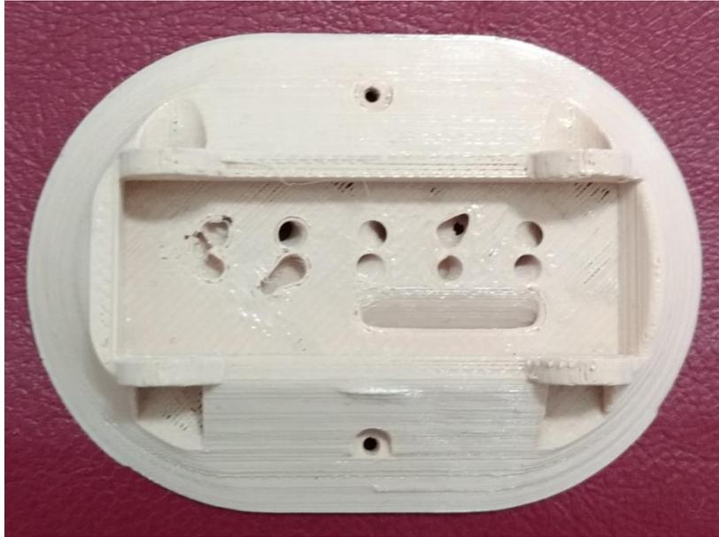
Ilustración 87 – Guía de transmisión utilizada para comunicar la tanza. Sirve también para adaptar el antebrazo con la palma.
