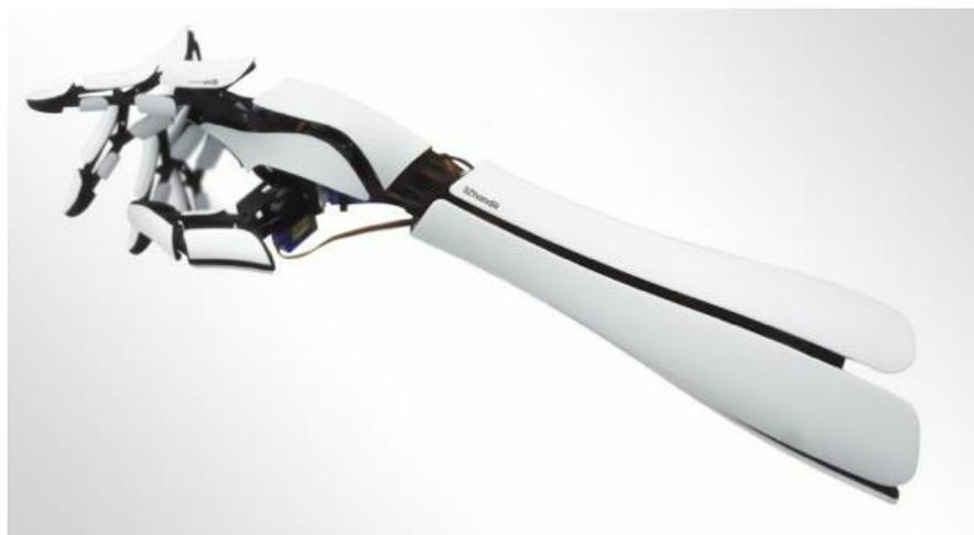
Ilustración 35 - Prótesis mioeléctrica
