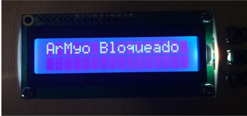
Ilustración 91 – Pantalla que muestra que la prótesis se encuentra bloqueada
