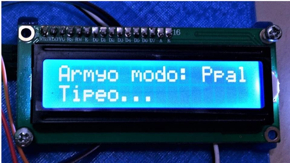
Ilustración 92 - Pantalla LCD que muestra que se detectó la señal y que se debe realizar el movimiento nuevamente
