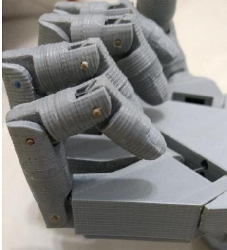
**Ilustración 101 – Articulación interfalángica distal. Se observa la flexión de la falange distal, que dificulta la prensión de objetos.**
