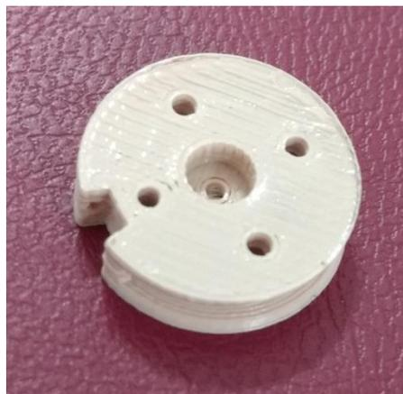
Ilustración 85 – Polea utilizada. Se ve en la parte superior los agujeros por donde el hilo circula y luego es atado.
