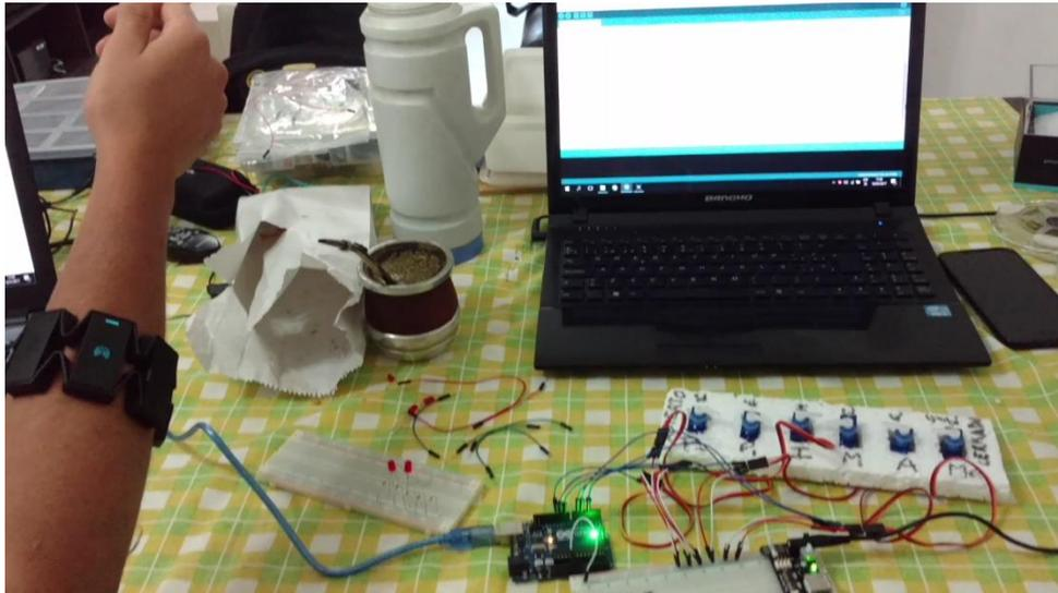
**Ilustración 73 - Conexión de Myo con placa Arduino mediante una PC y la aplicación MyoDuino**
