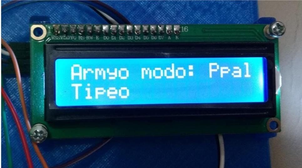
Ilustración 93 - Pantalla LCD mostrando que la señal fue detectada y la prótesis se movió a una posición de tipeo
