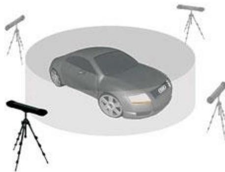
Ilustración 64 - Esquema de la tecnología de escaneo por pulso láser
