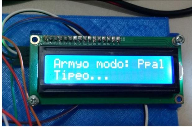
Ilustración 84 – Pantalla LCD. Muestra que la posición preseleccionada es la de tipeo. Los puntos suspensivos indican la preselección.
