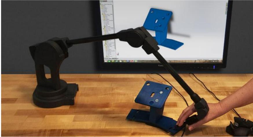
Ilustración 63 - Máquina de medición de coordenadas
