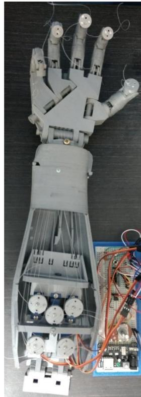
**Ilustración 100 – Primer prototipo implementado. Se observa en la parte debajo las poleas situadas sobre el eje de los servomotores**
