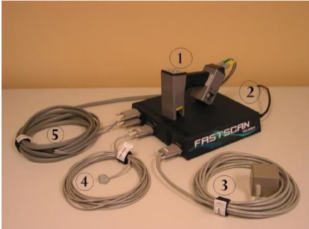
Ilustración 33. Componentes de FastScan. Referencias: Dispositivo de barrido y relevamiento (DBR) (1). Unidad de procesamiento (2). Transmisor (3). Receptor de referencia (4). Cable del dispositivo de barrido y relevamiento (5).
