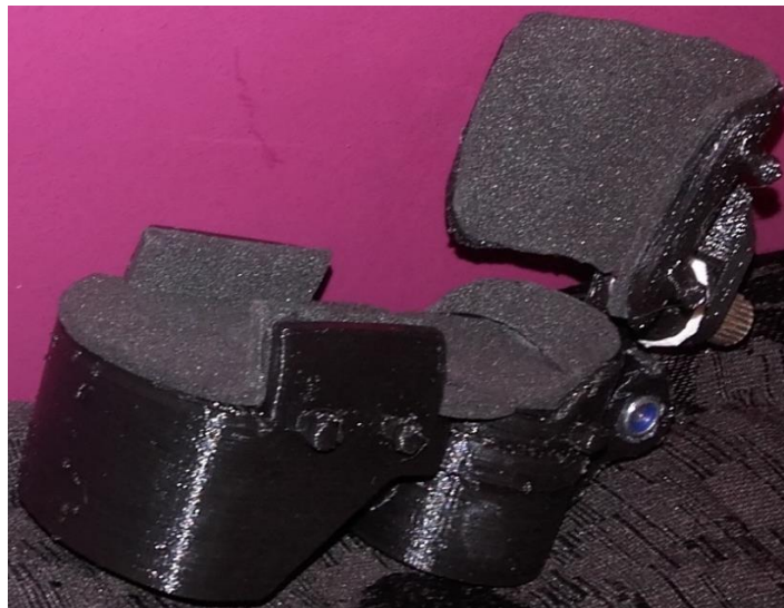
Ilustración 102. Prototipo modificado, donde se observan paredes de antepié envolventes y menor longitud de la pieza correspondiente a la pierna.
