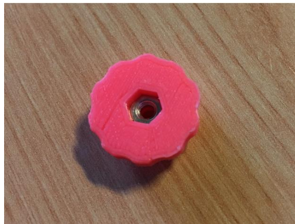
Ilustración 65. Adaptación 3D de una tuerca hexagonal para que funcione con ajuste manual.
