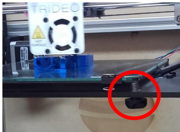
Ilustración 58. Tornillos y resortes ubicados en los cuatro extremos de la cama de impresión.
