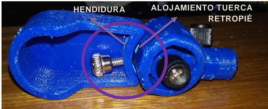
Ilustración 67. Vista inferior de la primera alternativa. Se observa la articulación que une antepié y retropié (círculo violeta).
