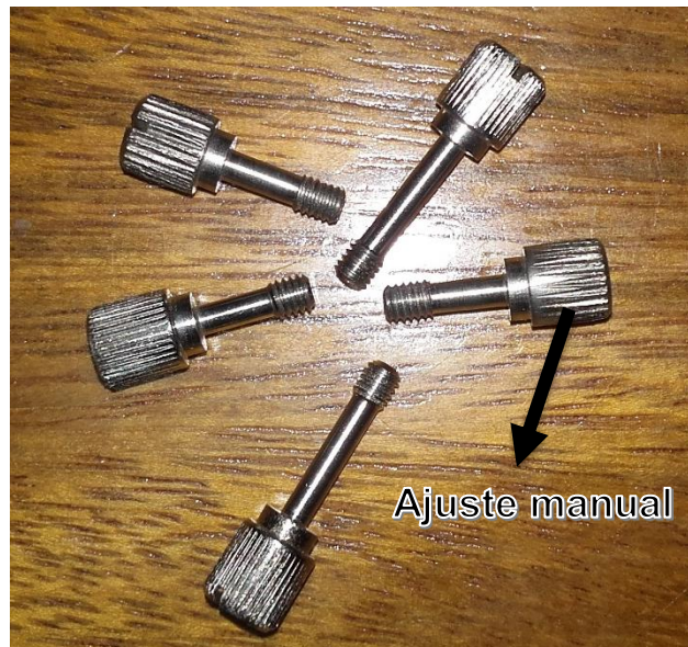
Ilustración 63. Tornillos M4 utilizados para el movimiento y la fijación de articulaciones.
