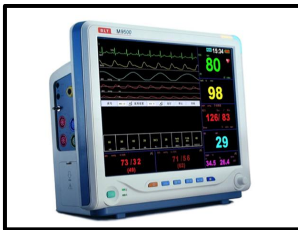
Figura 4.42 - Monitor multiparamétrico. Contiene un sistema de alarmas que alertan cuando existe alguna situación adversa o fuera de los límites deseados.
