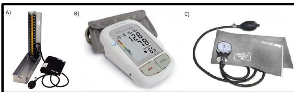
Figura 4.45 - Diferentes tipos de esfigmomanómetros. A) De mercurio; B) Oscilométrico; C) Aneroides.
