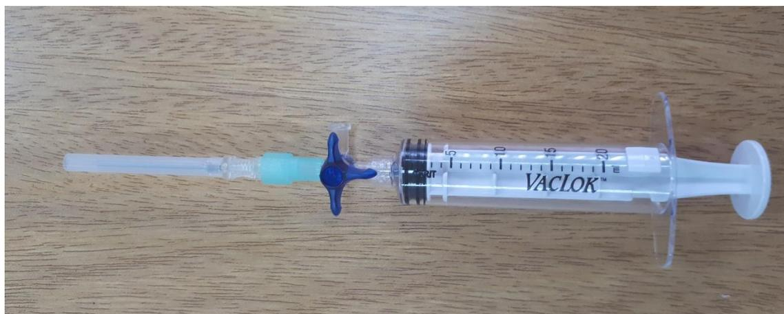
Ilustración 44. Jeringa y conector triple (aguja y sensor de presión).
