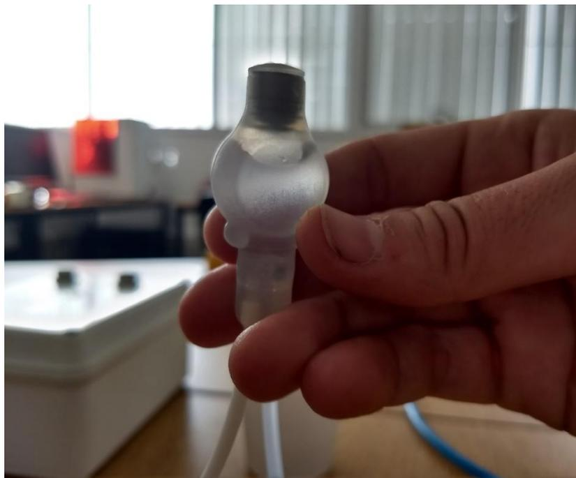
Ilustración 39. Burbuja de aire en la bomba.
