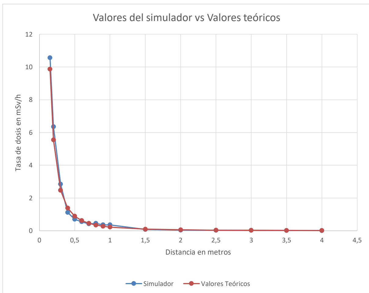
Ilustración 1 Gráfico de la comparación entre valores teóricos y los obtenidos por el simulador
