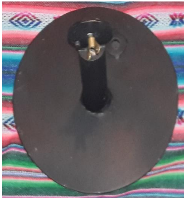
Ilustración 70: Base superior, vista superior. Se observa arriba el agujero para la fijación de la base.
