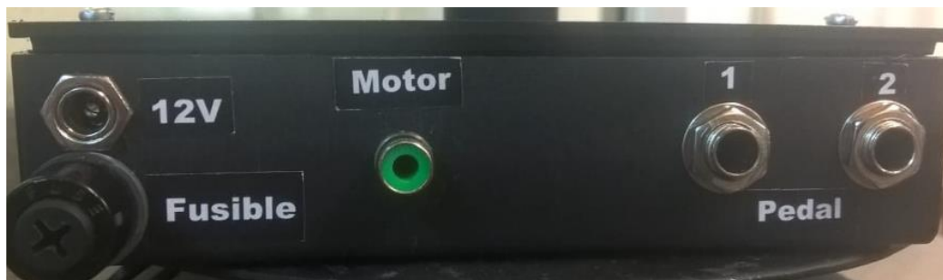
Ilustración 77: Vista posterior de la caja de control.
