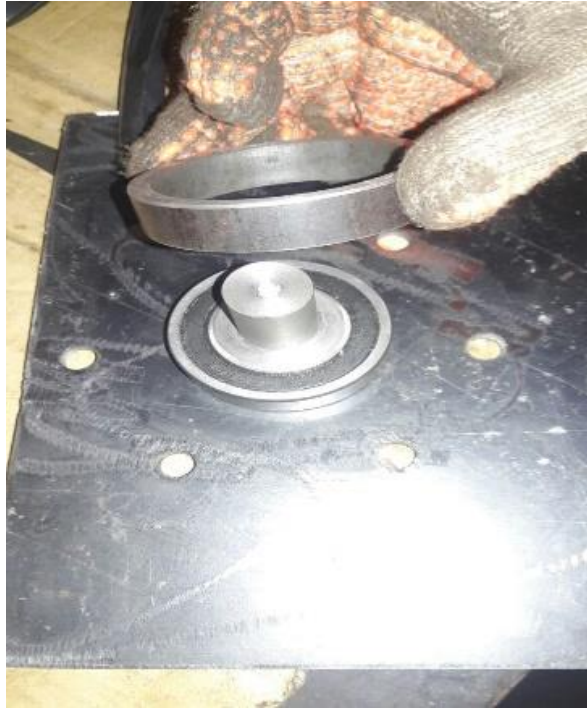
Ilustración 64: Proceso de fabricación de la base inferior, inserción del aro de hierro.
