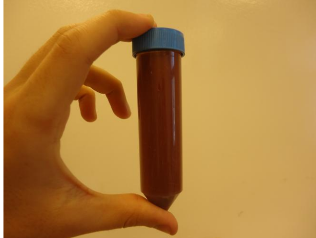
Figura 3.13. Estado de la muestra luego de ser puesto en contacto el material adsorbente y la solución fluorada.
