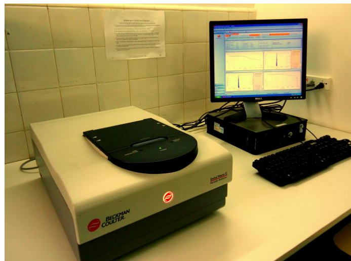
Figura 3.8. Equipo Zeta-Meter empleado para la medición del potencial zeta y tamaño de partículas.
