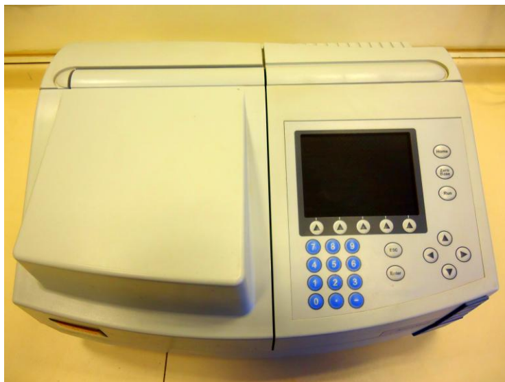
Figura 3.9. Espectrofotómetro AquaMate™ Vis, empleado en la determinación de fluoruros en solución.
