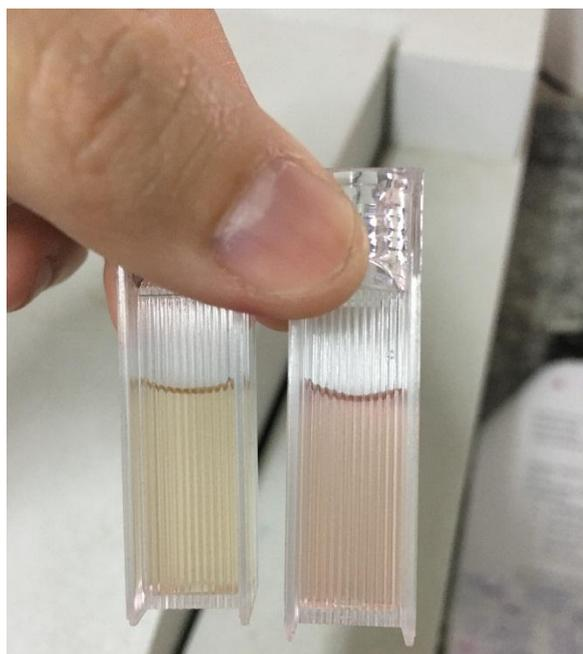
Figura 4.20. Comparación de reactivo de Schiff a 3 horas de reacción sin catalizador presente vs con catalizador presente respectivamente.
