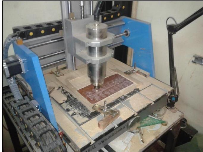
Figura 20. Máquina CNC realizando el fresado.
