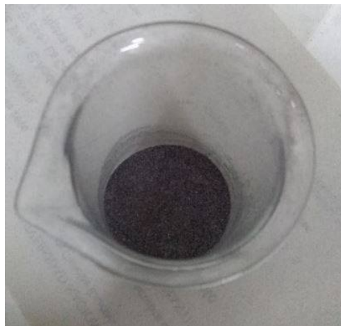
Figura 6-10: Magnesio puro con una granulometría menor a 500\mu m
