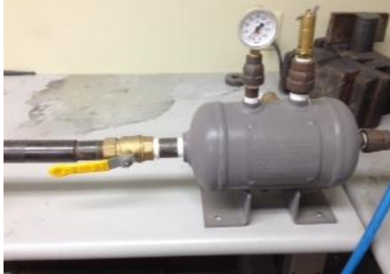
Figura 1-6: Sistema de disparo construido por Lang: [5]: al ser manual la liberación del aire comprimido, es poco probable obtener varias veces la misma velocidad de salida del proyectil.
