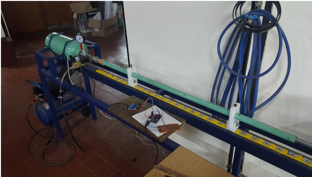
Figura 3-6: Sistema de disparo actual. ( Fotografía de elaboración propia )
