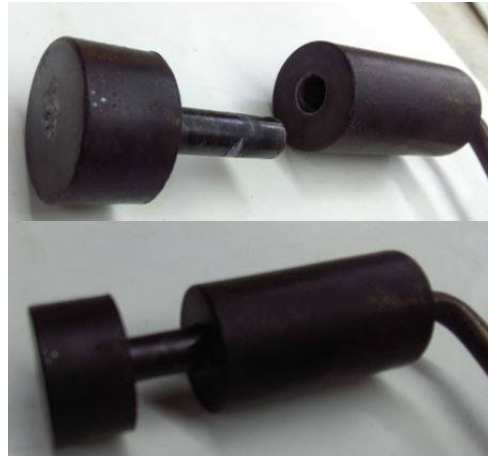
Figura 6-14 : Cámara en donde se alojan las probetas para su sinterizado.
