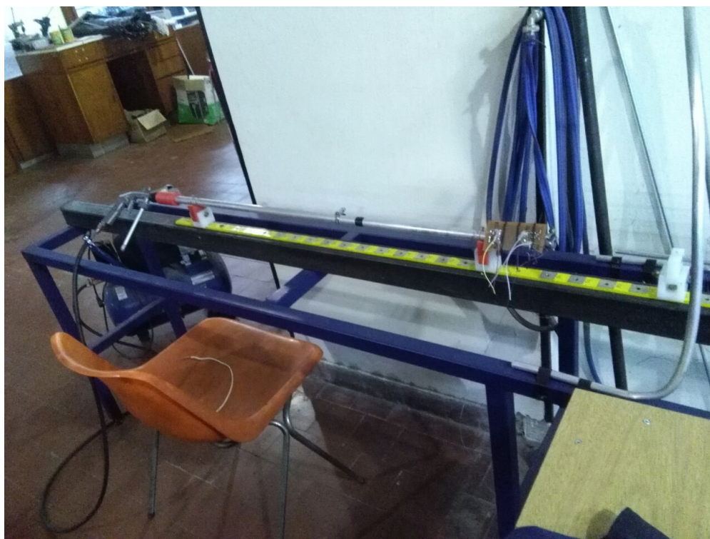
Figura 1-1: Máquina de Hopkinson original [Fotografía de elaboración propia]
