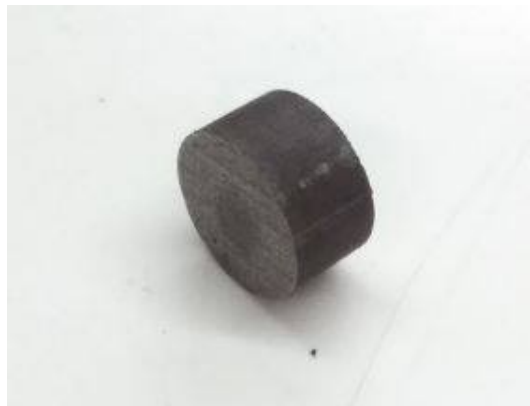
Figura 6-13: Probeta compactada, sin sinterizar.
