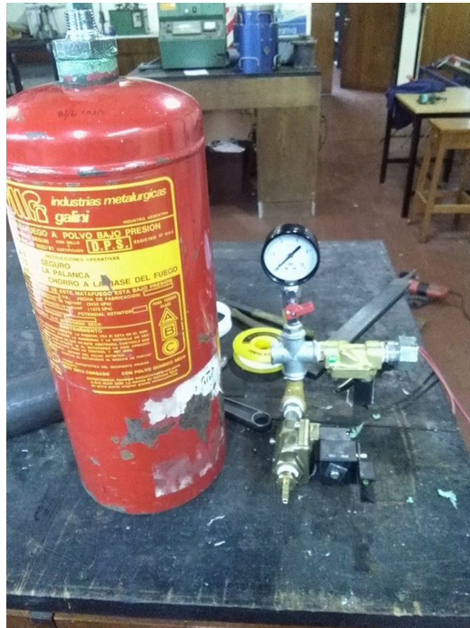
Figura 3-2: Depósito de aire comprimido y electroválvulas del sistema de propulsión. ( Fotografía de elaboración propia. )
