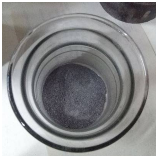
Figura 6-11 : Mezcla de magnesio y bicarbonato de amonio en diferentes porcentajes. ( Fotografía de elaboración propia )
