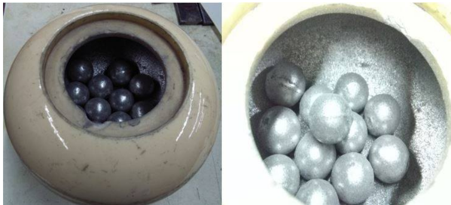
Figura 6-8: Recipiente en donde se introduce el magnesio puro para su posterior molienda.
