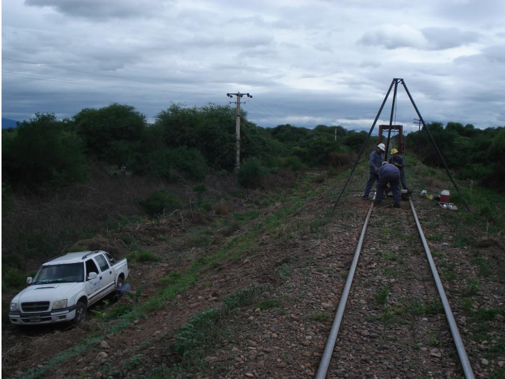
Figura 2.6: Ejecución del Ensayo SPT.
