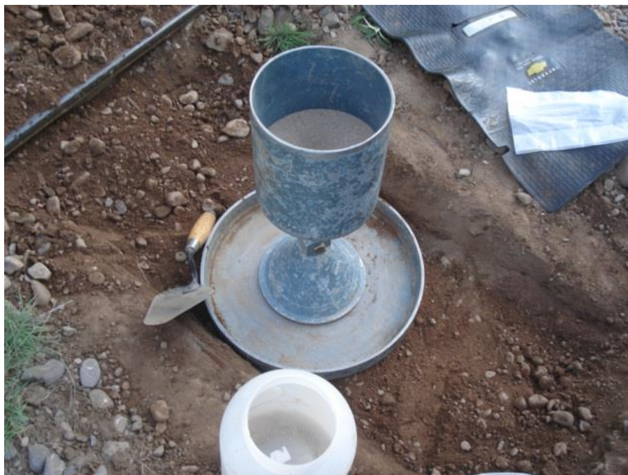
Figura 5.8: Ejecución del ensayo de densidad mediante cono de arena.
