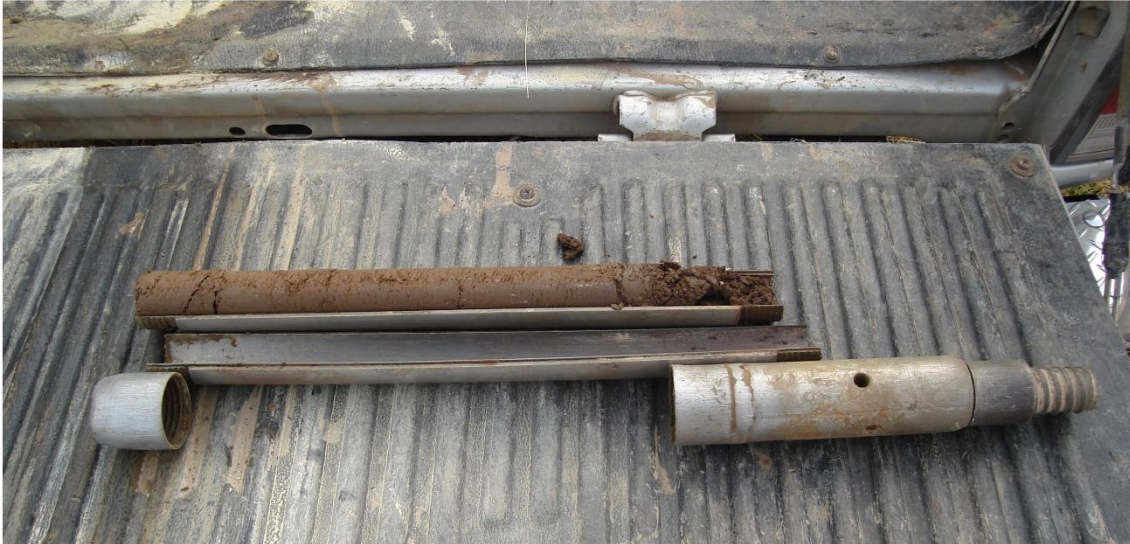
Figura 2.4: Muestreador bipartido de Terzaghi
