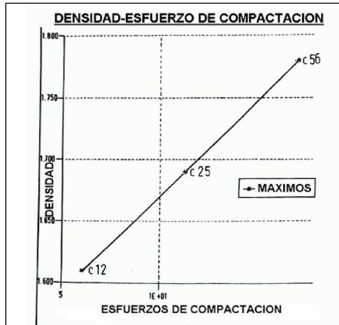
Figura 3.2: Curva Densidad – Esfuerzo de compactación.
