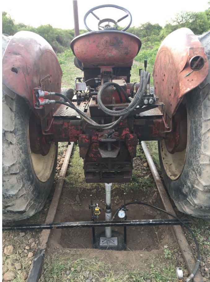
Figura 5.5: Ejecución del ensayo de Plato de Carga.
