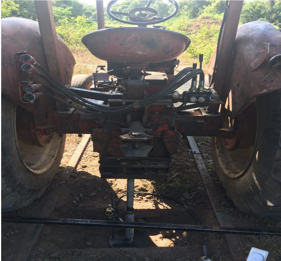
Figura 3.18: Ejecución del ensayo CBR in-situ entre las vías del tren.
