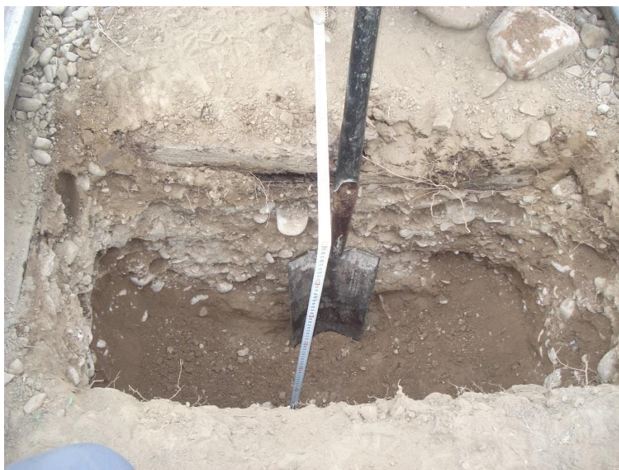
Figura 5.2: Ejecución del calicata.
