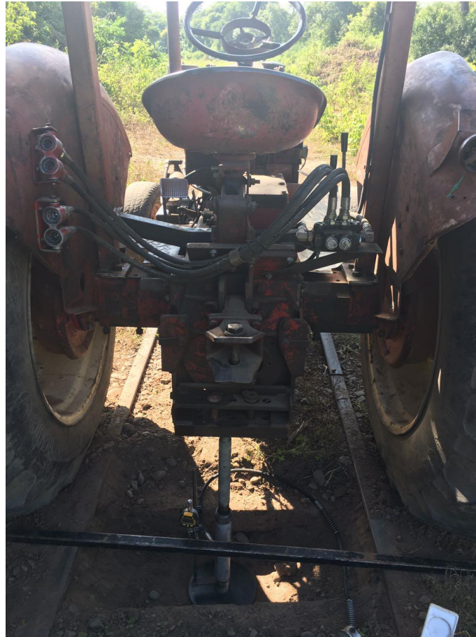
Figura 5.7: Ejecución del ensayo de CBR.
