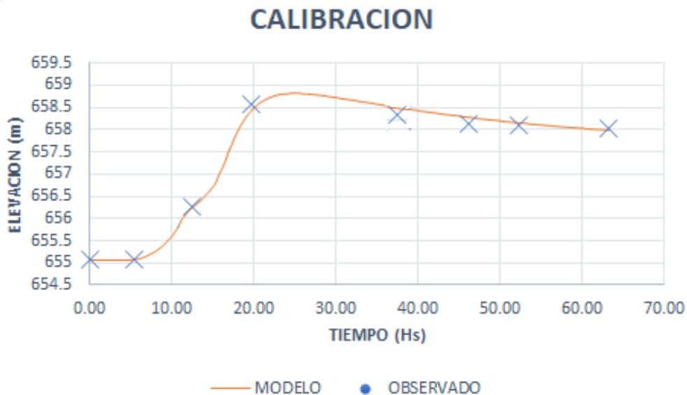
Figura 20: Comparación de Hidrogramas de salida de Embalse entre resultados del modelo y evento observado.
