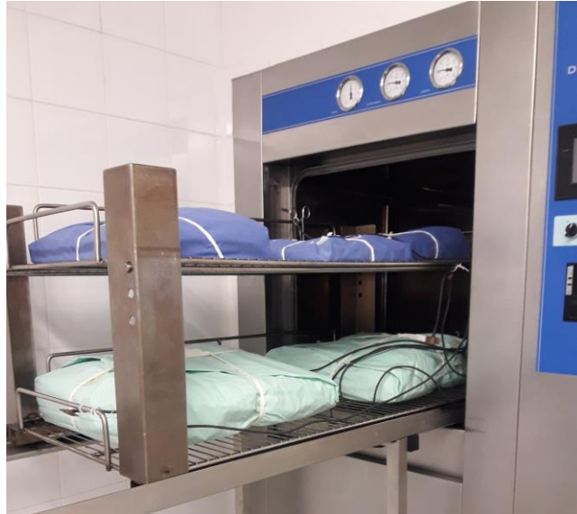
Imagen 6: Ubicación de la carga mixta (textil abajo) dentro de la autoclave
