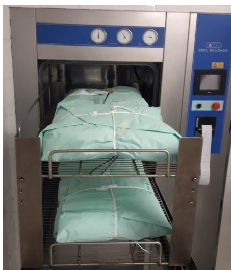
Imagen 3: Ubicación de la carga textil horizontal dentro de la autoclave
