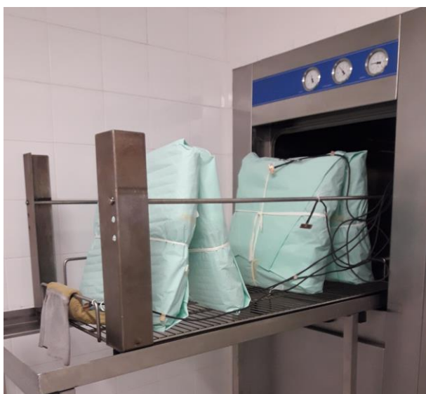
Imagen 4: Ubicación de la carga textil vertical dentro de la autoclave
