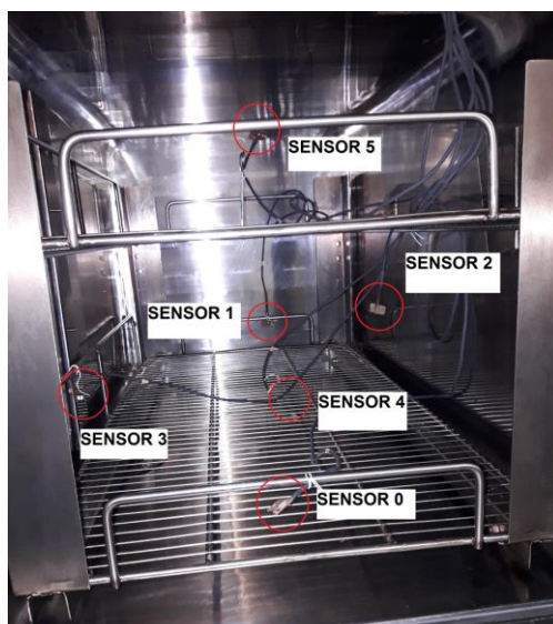
Imagen 2: Ubicación de los sensores dentro de la autoclave
