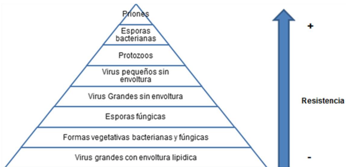
Ilustración 7: Esquema de susceptibilidad de los microorganismos a los procesos de esterilización (Maillard, 2004)
