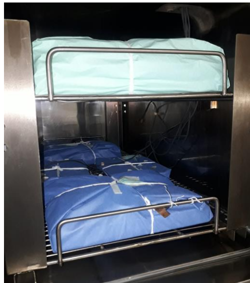
Imagen 5: Ubicación de la carga mixta (textil arriba) dentro de la autoclave
