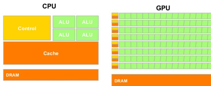
Figura 3.1: Arquitectura CPU y GPU
