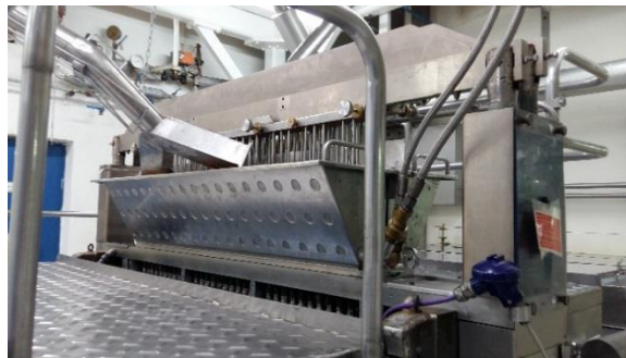
2- Línea Industrial 3 (visualización de Tolva 1 y 2, varillas y bloque)
