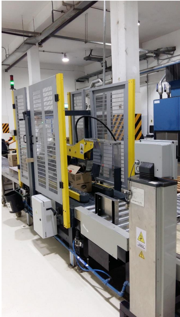
12- Empaquetadora totalmente automática, coloca en cajas las bolsas de caramelos de 1 KG.
