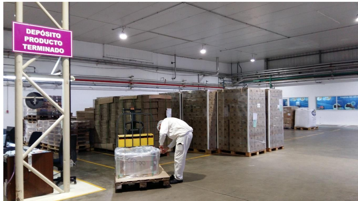
13- Depósito de Producto Terminado. Las cajas se colocan en pallets y luego se envuelven en film stretch.
