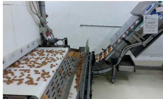
5- Salida del túnel de frío e ingreso a envasadora.
