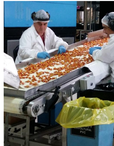
8- Selección de caramelos Butter Toffes ya envueltos. En ésta etapa se quitan del proceso los caramelos desenvueltos y/o con algún otro defecto. Es un Proceso totalmente manual. Los caramelos defectuosos se descartan (tacho azul)
