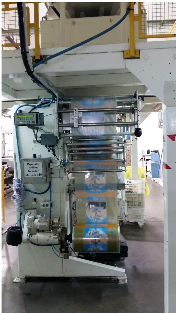
10-Envasadora de caramelos Butter Toffes en formato de 1 KG.
