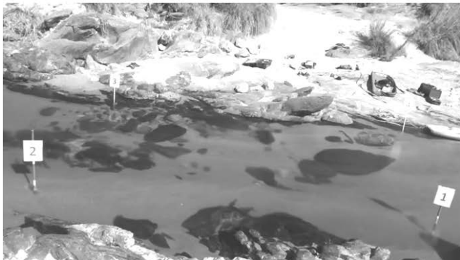
Figura 6. Ejemplo de rectificación digital de la zona de interés del río San Antonio al primer tramo: A la izquierda imagen original de la zona de interés con los 4 puntos de control, a la derecha la misma imagen rectificada en un plan ortogonal. Para disminuir el costo computacional, en el post-procesamiento, una imagen única es rectificada para poder graficar encima los resultados rectificados.
