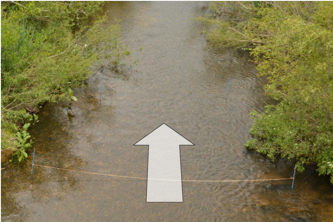
Figura XI.6 Sección de interés del arroyo Maldonado visto desde el puente de la ruta 9. La 4 PCs utilizados para la rectificación de los resultados se encuentran donde la superficie del agua cruz cada una de las estacas (azul)
