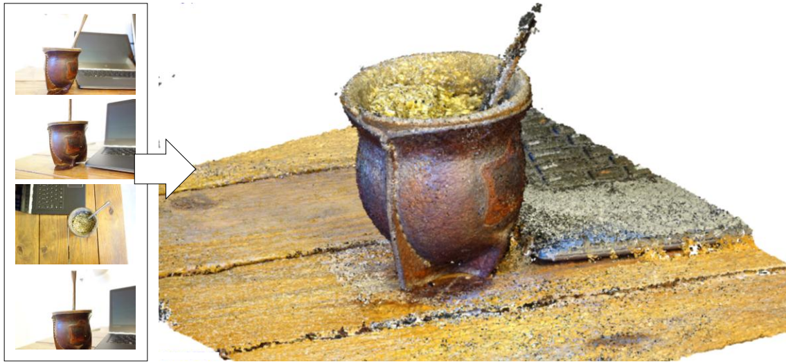
Figura II.8 Ejemplo de modelo 3D generado con SFM a partir de un juego de imágenes de una misma escena
