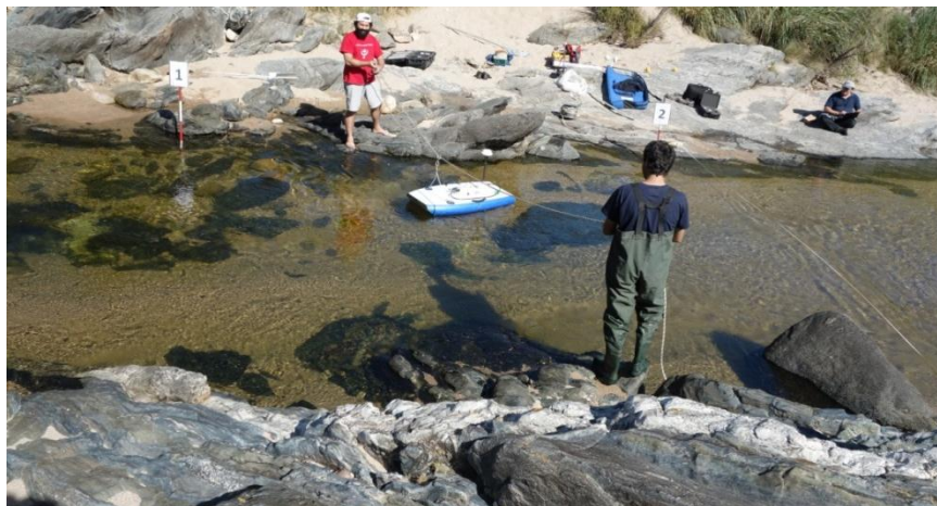
Figura V.3 Medición con ADCP en la sección de estudio en el río San Antonio en proximidades de la localidad de Cuesta Blanca
