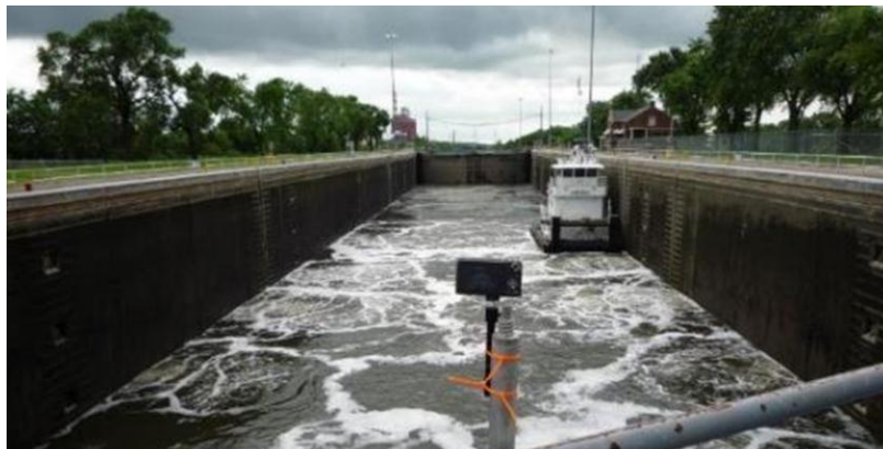
Figura VIII.2 Ejemplo en donde una cámara digital se apoyó sobre una baranda por encima de una compuerta.
