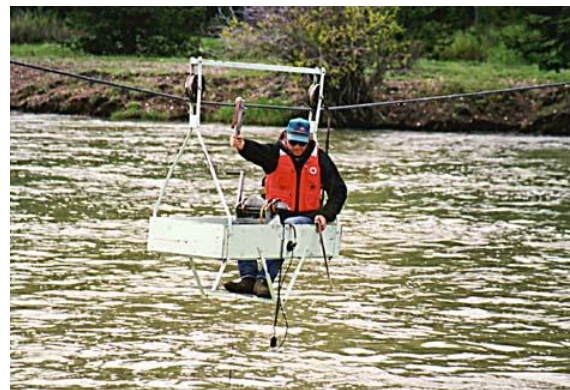
Figura I.8 Aforo con molinete desde un cable carril en 1880 a la izquierda, en 1996 a la derecha (imágenes USGS).
