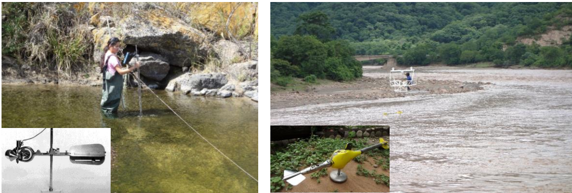
Figura I.3. De la izquierda a la derecha: medición de caudal con molinete por vadeo, desde un cable carril en el río Anisacate, el río Pilcomayo y respectivamente.
