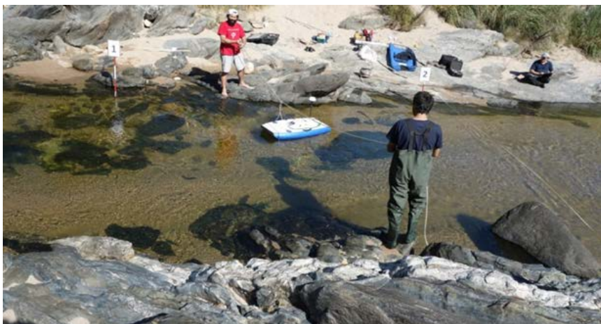
Figura 3. Medición con ADCP en la sección de estudio en el río San Antonio en proximidades de la localidad de Cuesta Blanca.
