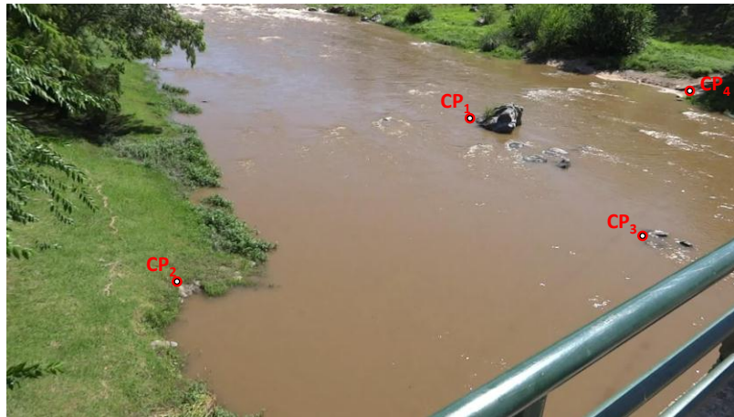
Figura VIII.3 Imagen de un video tomado desde un Puente en donde los puntos de control son rocas.
