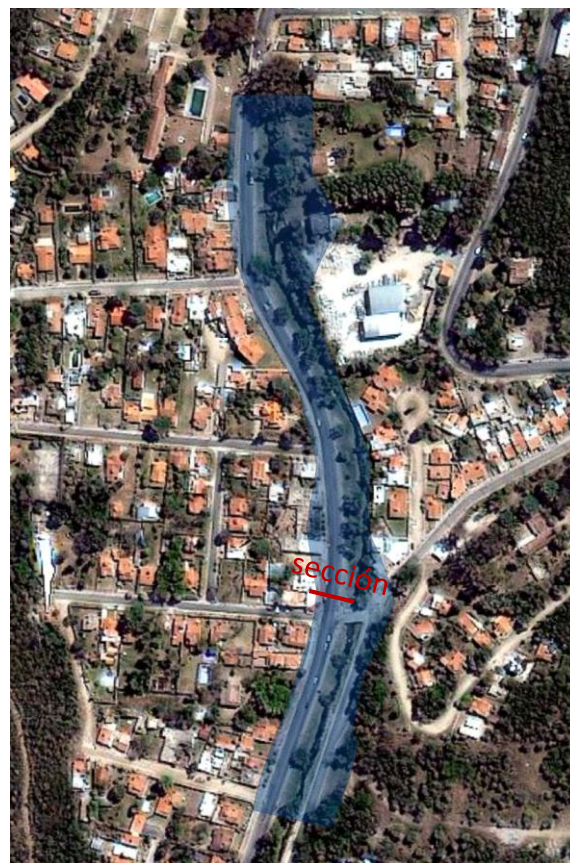
Figura X.5 Área inundada calcula utilizando el modelo de inundación HEC-RAS, calibrado con el campo de velocidades obtenido con LSPIV y la marca de agua. EL caudal pico estimado fue de 290 m 3 /s
