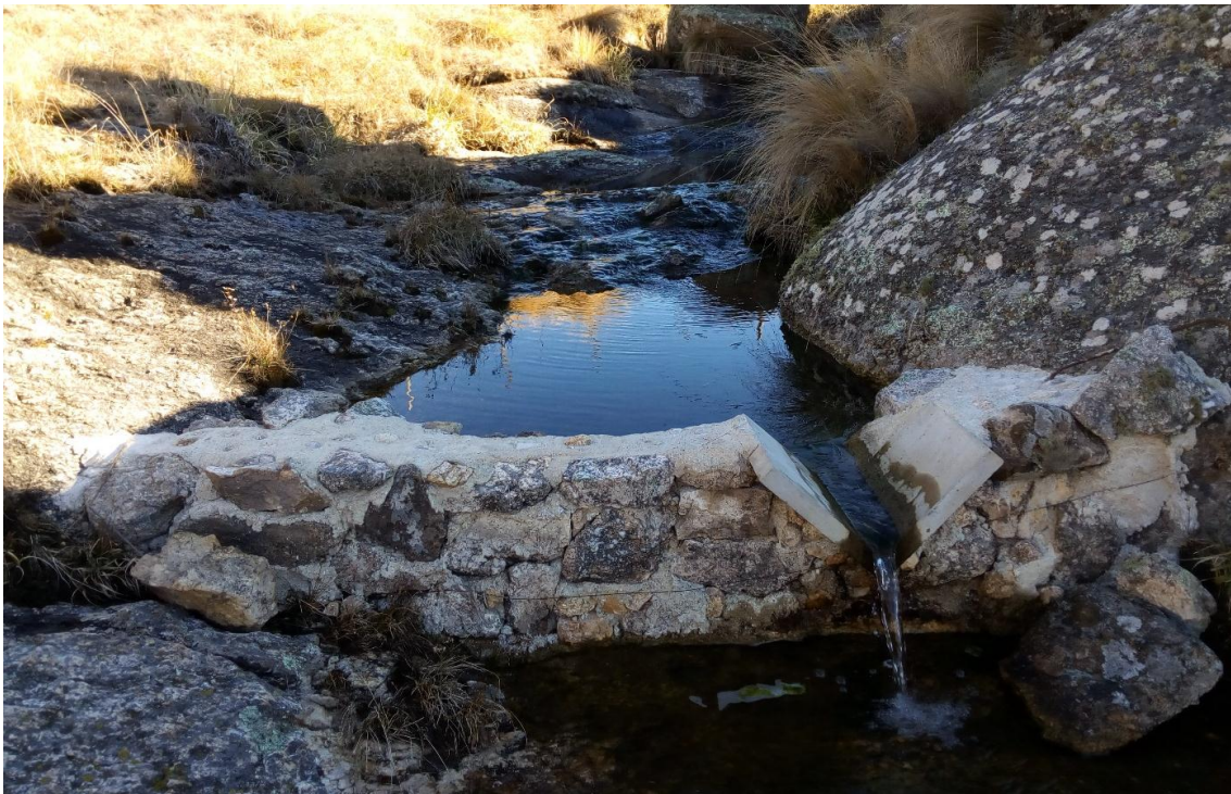
Figura I.1 Vertedero para la cuantificación del caudal por método volumétrico de un arroyo (Los Gigantes, Córdoba, Argentina, 2016), foto Silvia Navarro
