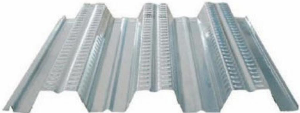
El diseño geométrico de las placas en forma de TRAPEZIO con 7,5 cm de alto, incrementa las propiedades resistentes efectivas, posibilitando mayores vanos sin apoyos intermedios y una mayor capacidad de carga.
