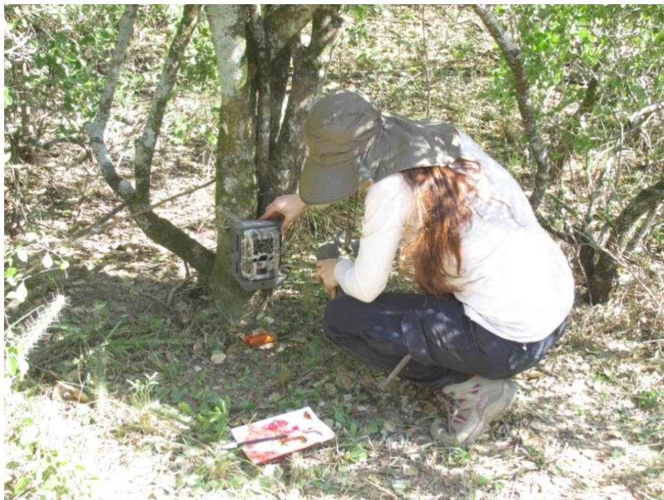
Figura 6: Cámara trampa ubicada en una de las estaciones de muestreo dentro de La Fidelidad (Foto: Yamil Di Blanco).
