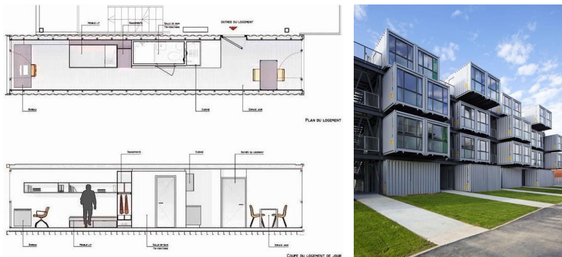
Figuras 54. Planta y sección longitudinal de una unidad e imagen del conjunto.
