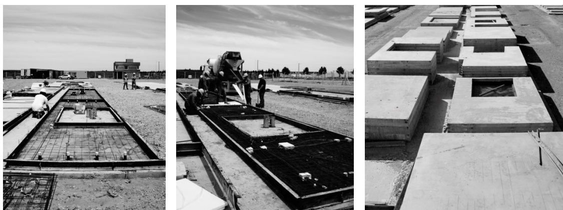
Figuras 50. Proceso de producción de paneles.
