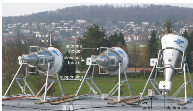
Figura 2.10: Radiómetro en banda L (1-2 GHz) para medir humedad de suelo Fuente: "Molecular Diversity Preservation International", M.Schwank et al., 2010.
