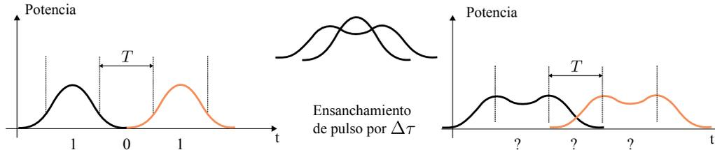
Figura 2.5. Interferencia entre símbolos producida por la PMD.
