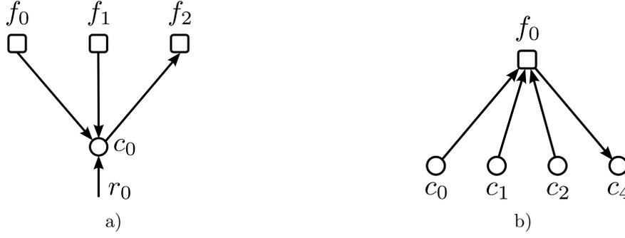
**Figura 3.3.** Subgrafo de un grafo de Tanner correspondiente a una matriz  $H$  cuya: a) columna cero es  $[11100 \cdots 0]^T$ , b) fila cero es  $[110100 \cdots 0]^T$ . Las flechas indican el paso de mensajes entre nodos.
