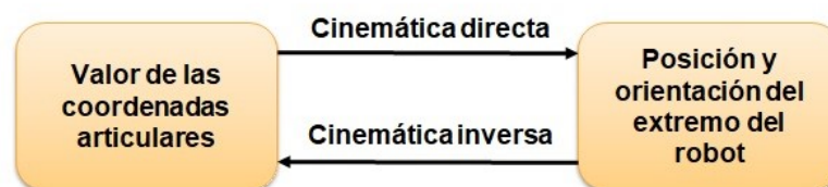
Imagen 55: Representación esquemática de la cinemática de un robot.
