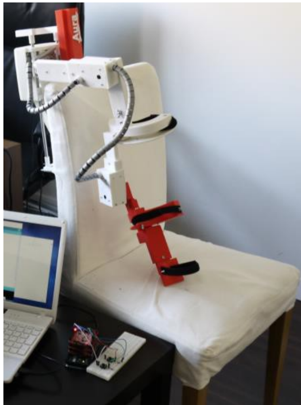
Imagen 52: Prototipo de exoesqueleto de miembro superior para rehabilitación, desarrollado en la empresa Aura Innovative Robotics.
