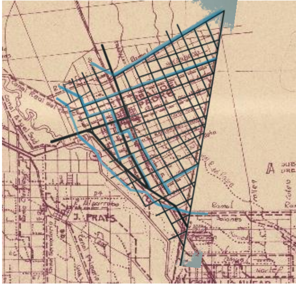
Fragmento del plano de planimetría general del Río Atuel con indicación de zonas de riego y canales derivados del Departamento General de Irrigación de la provincia de Mendoza, donde se ven resaltados los canales de riego de Real del Padre, dentro de la trama de caminos, y como éstos se vinculan dentro del área bajo riego próxima
