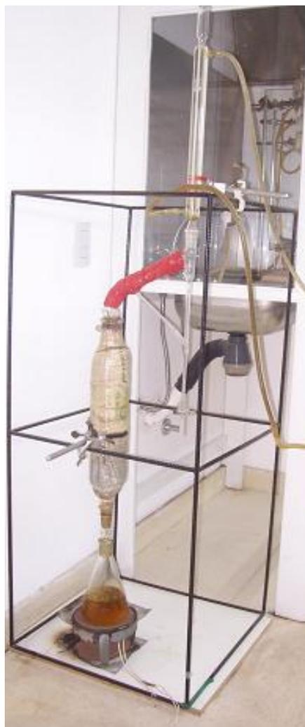
Figura 4.1. Destilador tipo Clevenger para la obtención de aceite esencial.
