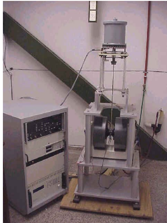
Fig. 3.6: VSM Lakeshore 7300, GCM-FaMAF.
