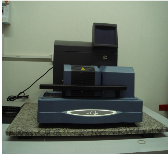
Fig. 3.7 b): Calorímetro diferencial dual (TG - DSC), SDT Q-600, TA Instruments , GCM, FaMAF.
