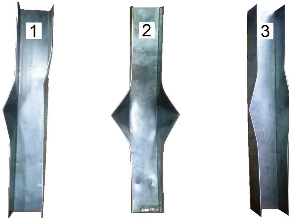
Figura 3.2 (d) Perfiles deformados luego de los ensayos
