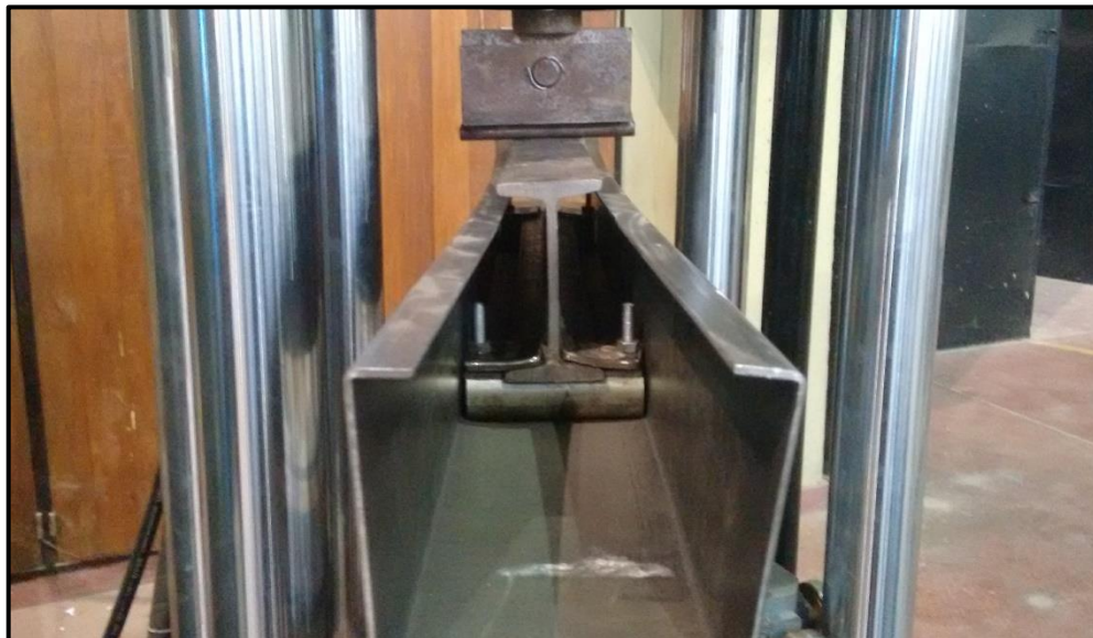
Figura 8.5 (e) Perfil con deformación elástica en el centro
