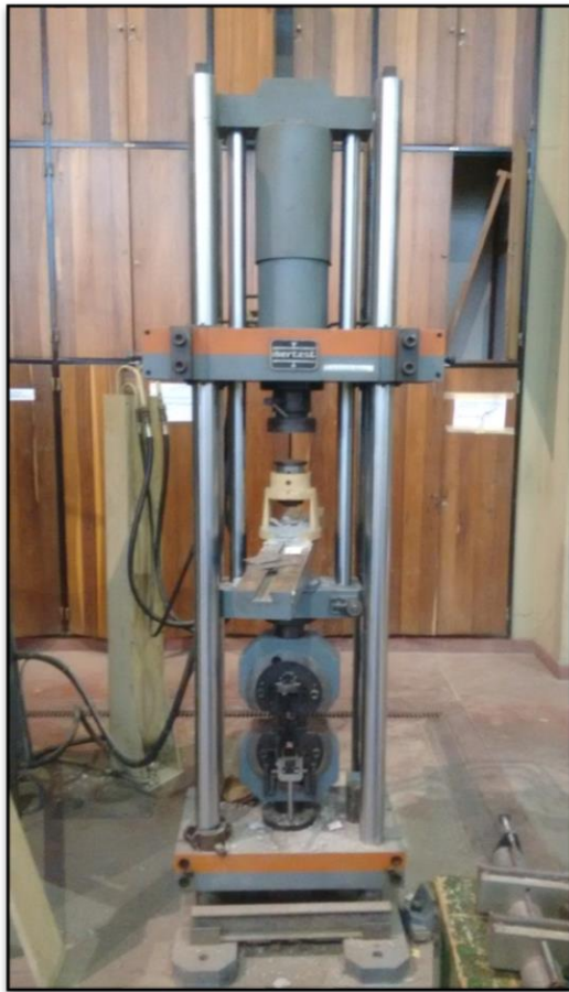
Figura 8.1.2 (a) Elementos que realizan esfuerzos
