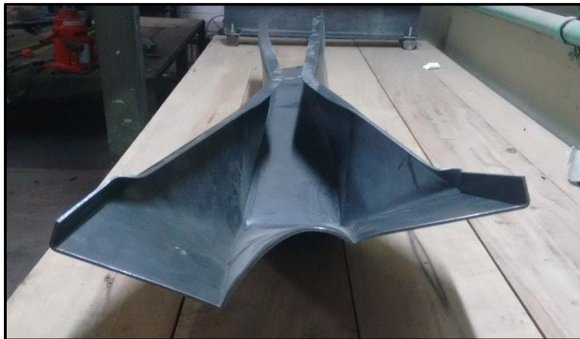
Figura 8.5 (g) Perfil deformado plásticamente después del ensayo
