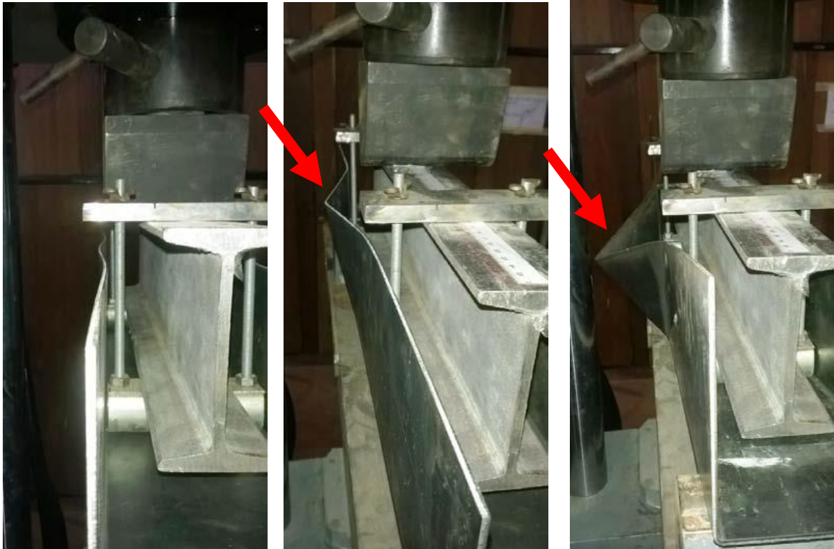
Figura 3.2 (c) Deformación progresiva de las alas
