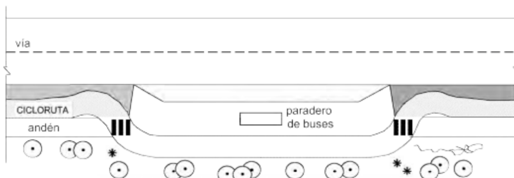
Figura N° 20: CICLORUTA EN PARADA DE BUS. (Fuente: Manual de diseño de ciclorutas de Bogotá)
