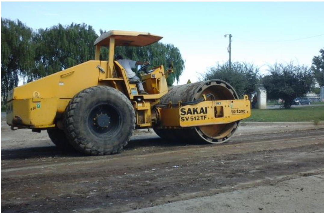
Figura N° 60: Compactador de rodillo liso vibratorio. (Fuente: Elaboración Propia).
