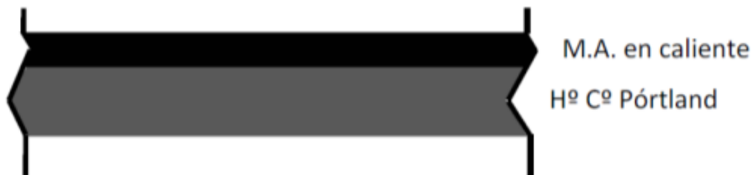
Figura N° 49: Pavimento Compuesto. (Fuente: Catedra Transporte III).
