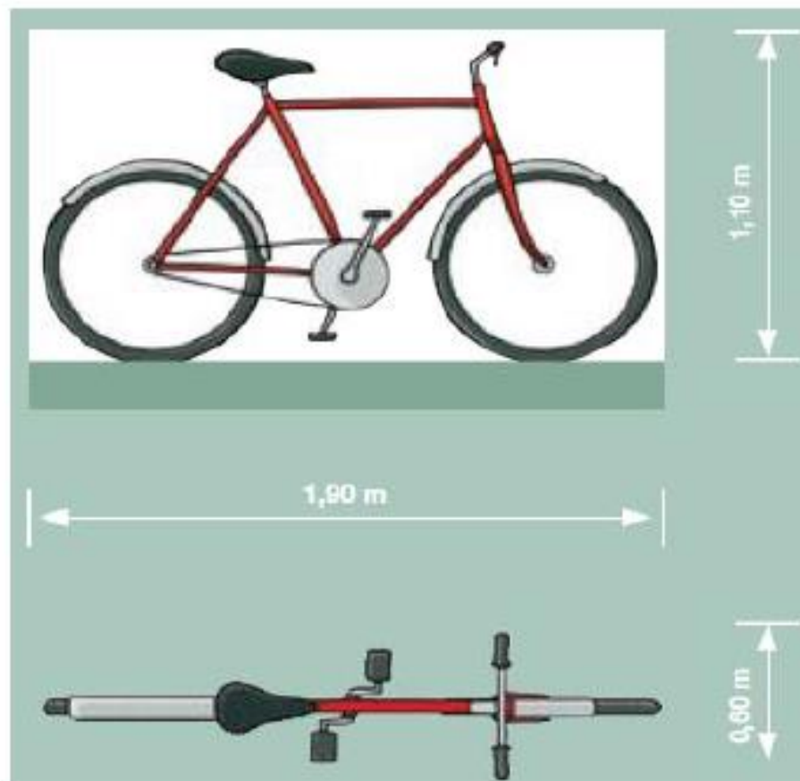
Figura N° 7: Dimensiones de bicicleta tipo. (Fuente: Manual para el diseño de vías ciclista de Cataluña).
