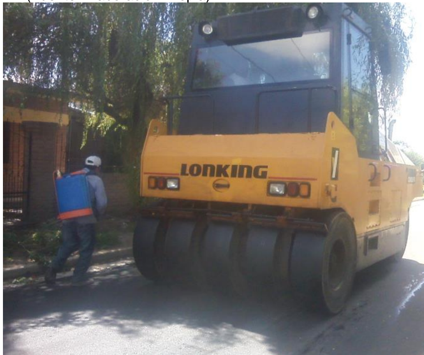
Figura N° 70: Compactador de rodillos neumáticos. (Fuente: Elaboración Propia)
