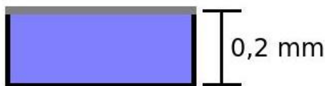
Figura 4.2: Esquema representativo del aspecto final de lámina de Al pulida electroquímicamente.
