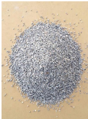
Figura N° 7. Muestra árido reciclado de hormigón (intermedio)
