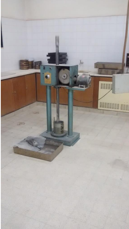
Figura N° 33. Compactación – Máquina compactadora
