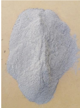
Figura N° 8. Muestra árido reciclado de hormigón (fino)
