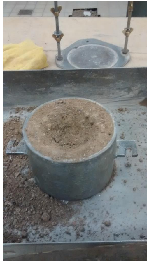
Figura N° 34. Compactación – Toma de muestra
