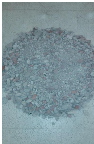
Figura N° 5. Muestra árido reciclado mixto de hormigón
