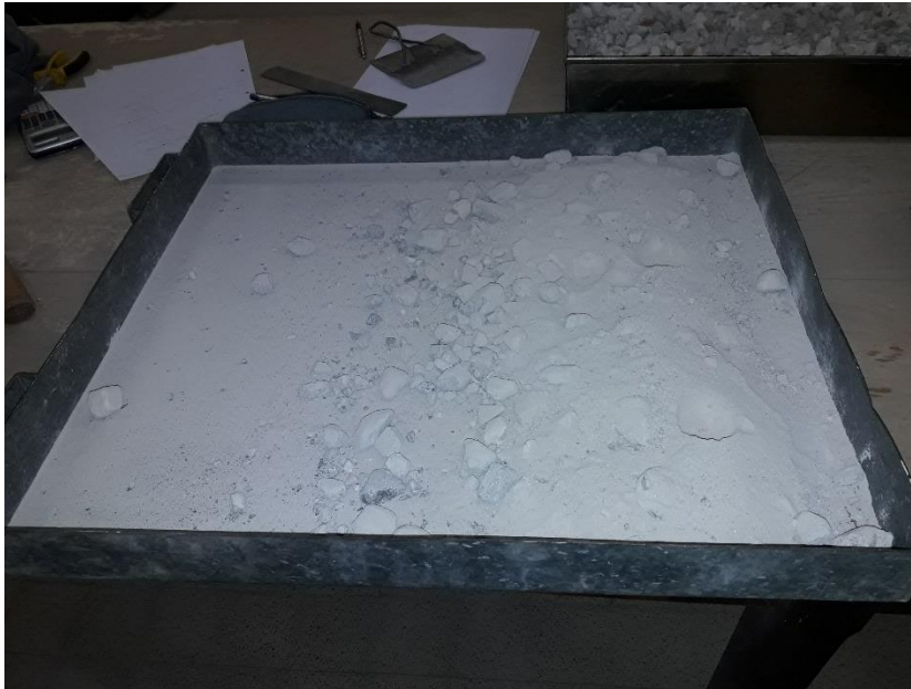
Figura N° 32. Desgaste – Material resultante del desgaste
