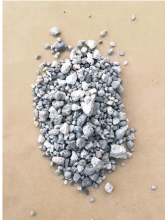
Figura N° 6. Muestra árido reciclado de hormigón (grueso)
