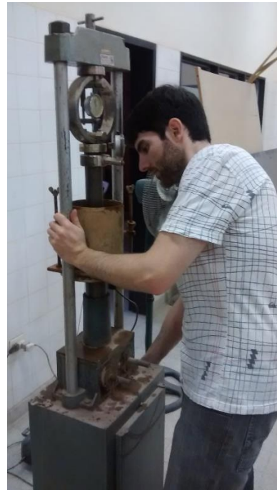
Figura N° 47. CBR – Probeta ensayada
