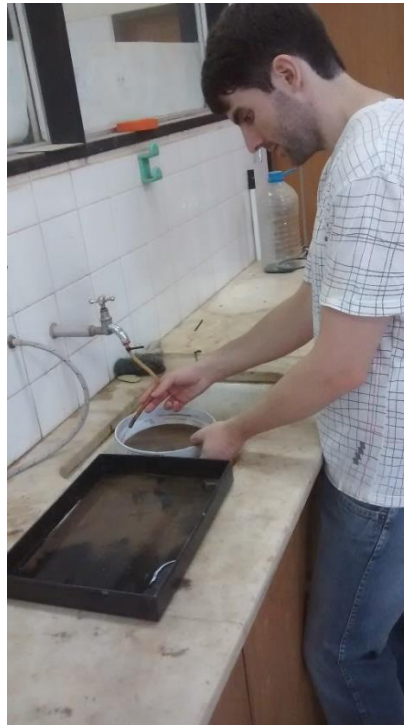
Figura N° 14. Granulometría – Retenido T N° 200
