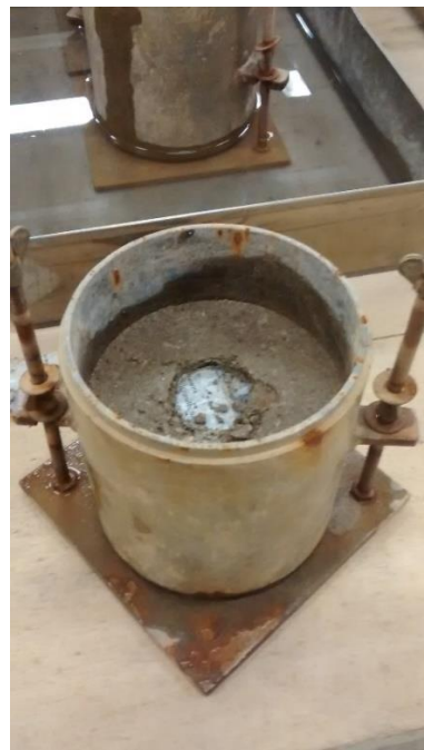
Figura N° 47. CBR – Probeta ensayada
