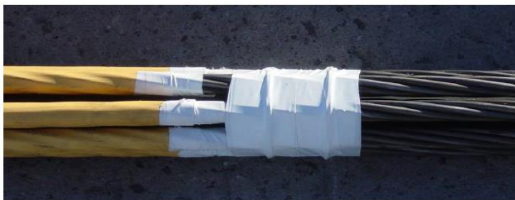
Figura 17: Transición entre el tramo envainado y engrasado de los cordones trenzados y el tramo desnudo (Leoni 2010).
