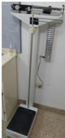
Balanza de pie y altímetro “C.A.M.” de precisión
