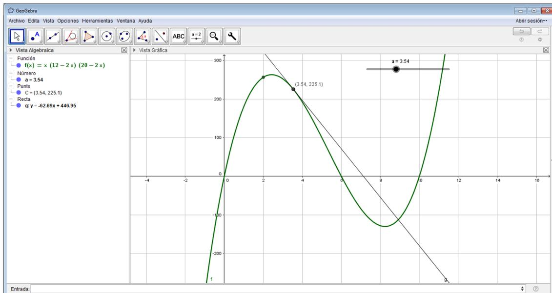
Figura 9: Gráfico de una recta tangente al gráfico de la función utilizando GeoGebra.
