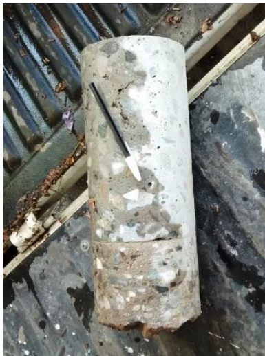
5.72 Testigo con presencia de oquedades 5.73 Prensa para ensayar a Compresión Simple
