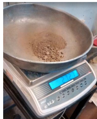
5.10 Secado del suelo y Peso del mismo sin humedad
