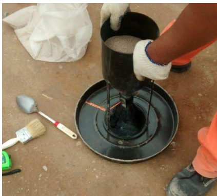
5.8 Vertido y Remoción de la Arena en el pozo
