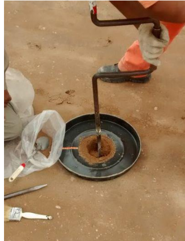
5.7 Realizado del Pozo para ensayo de Cono de Arena
