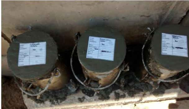
5.58 Probetas de Hormigón moldeadas e identificadas
