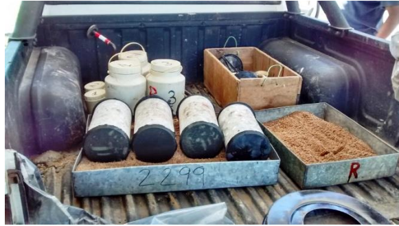
5.71 Testigos encabezados y preparados para ser ensayados a Compresión
