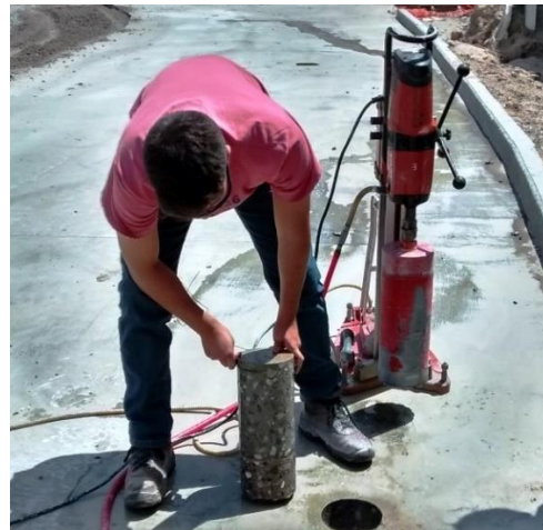
5.68 Extracción de testigos de Hormigón
