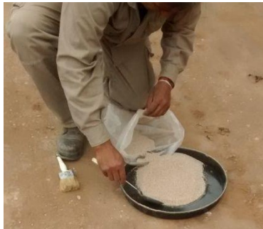
5.7 Realizado del Pozo para ensayo de Cono de Arena
