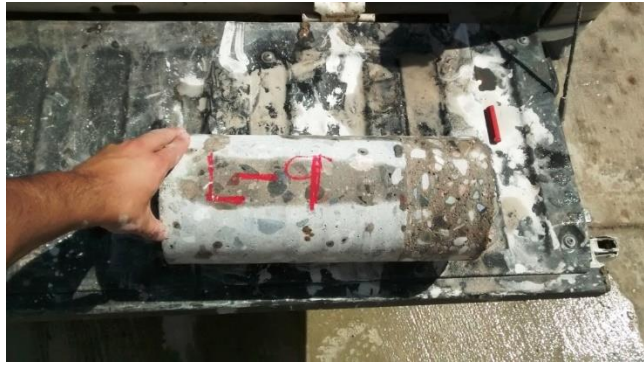
5.69 Medición e Identificación del Testigo
