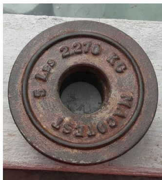
5.25 pesa anular de 2,27 Kg para ensayo de Penetración en CBR
