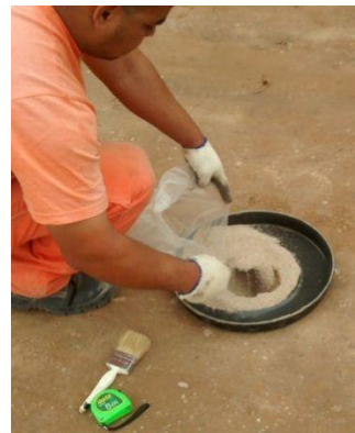
5.8 Vertido y Remoción de la Arena en el pozo
