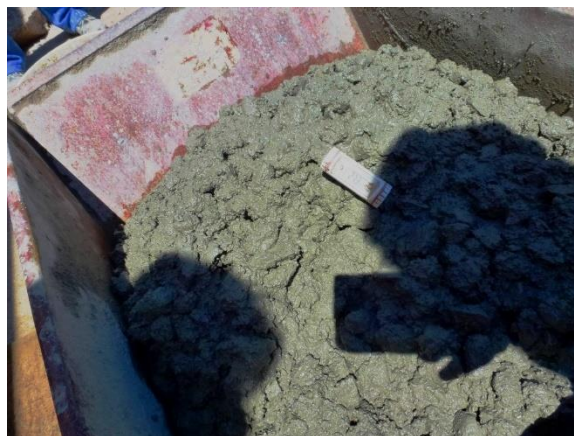
5.57 Termómetro digital tomando la temperatura de una muestra de Hormigón del Mixer
