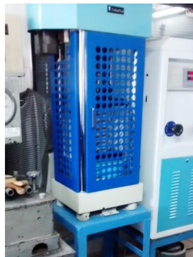
5.72 Testigo con presencia de oquedades 5.73 Prensa para ensayar a Compresión Simple
