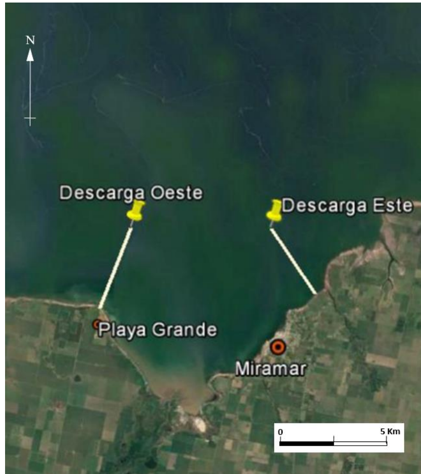
Figura 7.9 – Ubicación de los puntos de descarga. Fuente propia y Google Earth.
