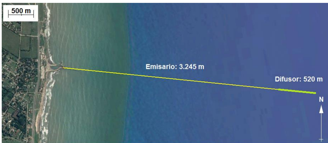
Figura 5.4 – Emisario de Mar del Plata. Muchiut (2016).
