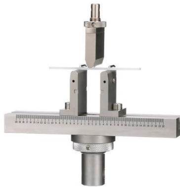
Figura 7. Modelo de sonda usada para medir fuerza de fractura de las pastas
