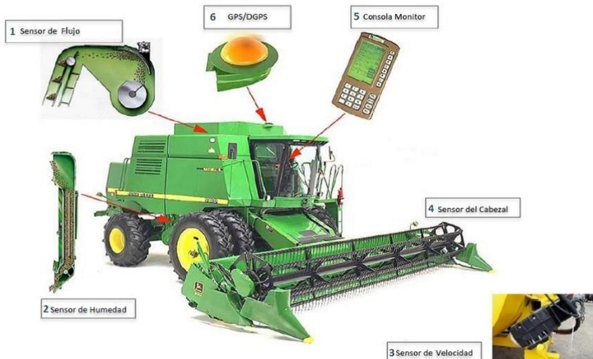
**Figura 2.4:** Principales componentes del monitor de rendimiento integrado en una máquina cosechadora.
