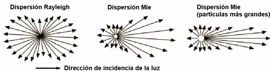
Figura 2.7: Características de las dispersiones Rayleigh (simétrica) y Mie (asimétrica) según el tamaño de las partículas respecto a la longitud de onda de la radiación incidente. Extraída de [2]
