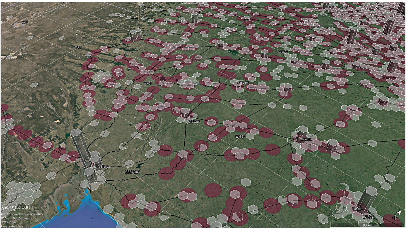
Arriba → Fig.4: Parte de la provincia de Buenos Aires y La Pampa. Los círculos representan un radio de 10km, centrado en una estación de ferrocarril. Las trazas negras representan los ferrocarriles.
