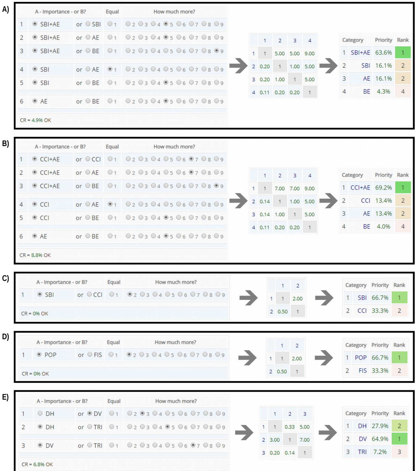
Figura 1: Comparaciones por pares de las variables, seguido por las matrices de los juicios y en el último paso, el valor de los pesos arrojados por el método AHP. Las imágenes corresponden a capturas de pantalla del programa disponible on-line a la página http://bpmsg.com .
